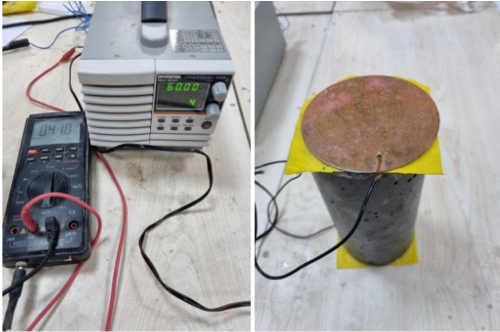
řekil 14. Elektriksel 6zdiren6 deneyi d6zeneęi
