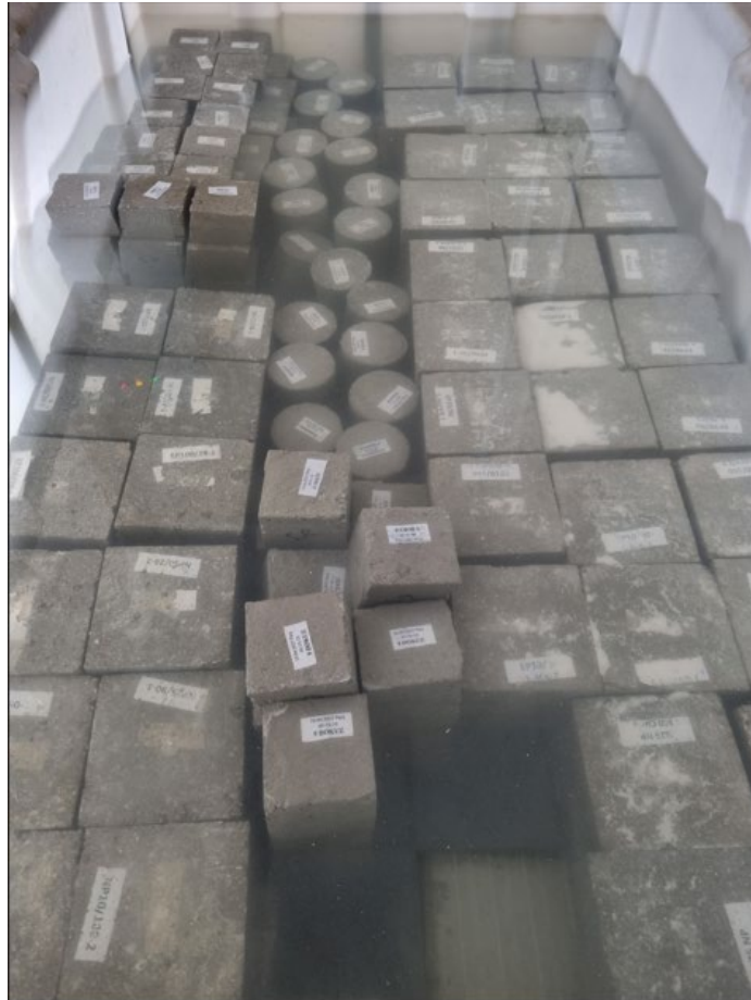
Şekil 8. Numunelerin kürlendiği kür havuzu
