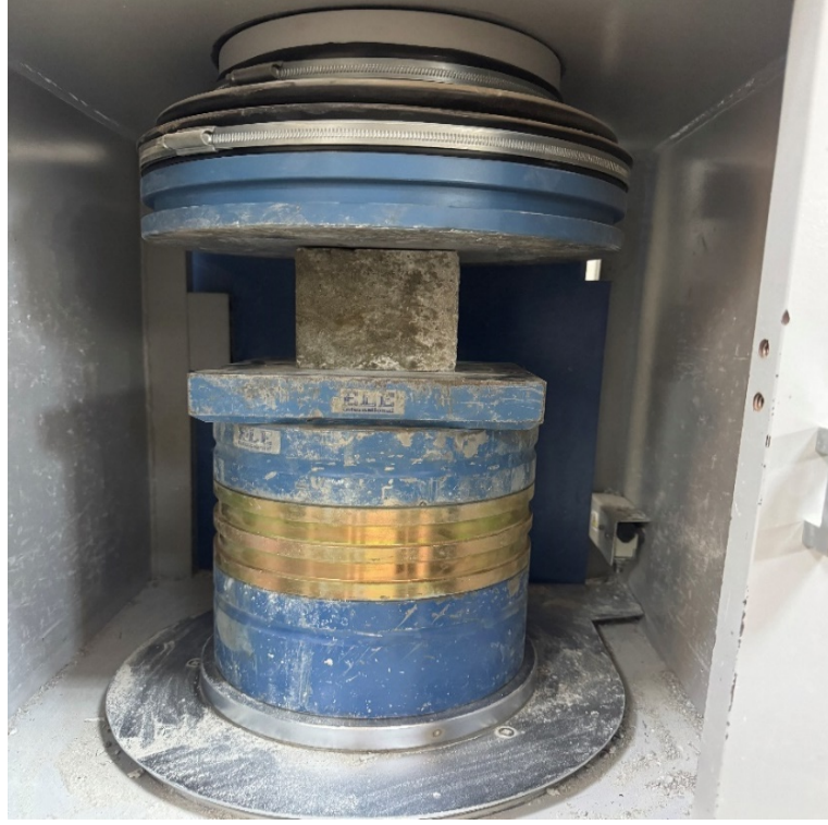
Şekil 12. Basınç dayanımı testi
