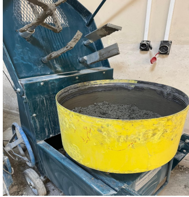
Şekil 6. Hafif betonların üretiminde kullanılan karıştırıcı
