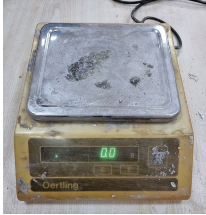
Şekil 9. Tartımlarda kullanılan 0,1 g hassasiyetli terazi
