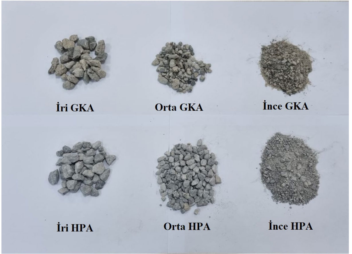
Şekil 4. Hafif betonların üretiminde kullanılan agregalar
