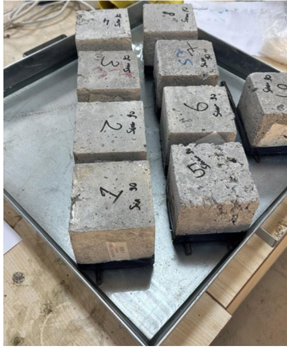
Şekil 15. Kılcallık katsayısı tayini deney düzeneği
