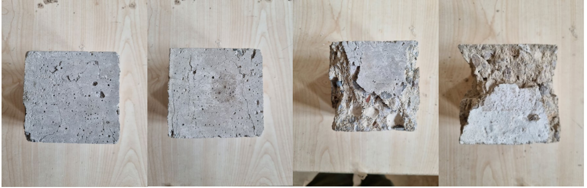
Şekil 25. Yüksek sıcaklık etkisine maruz kalmış numunelerin basınç dayanımı testi sonrası görüntüleri (Soldan sağa; oda sıcaklığı, 250°C, 500°C ve 750°C)
