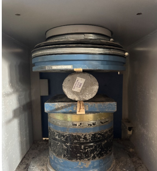
Şekil 13. Yarmada çekme dayanımı testi
