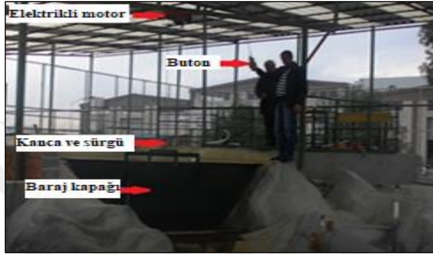
Şekil 3.6 Deney başlamadan önce kapalı durumdaki baraj kapağı (Kişisel arşiv, 2013)
