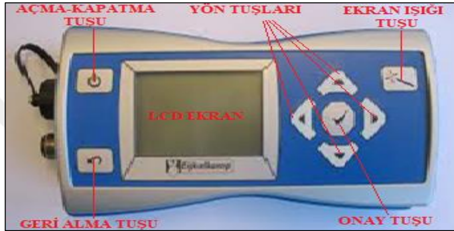
Şekil EK 2.1 Seviye ölçümünde kullanılan kontrol cihazının üzerinde bulunan tuşlar ve bu tuşların fonksiyonları (Kişisel arşiv, 2013)
