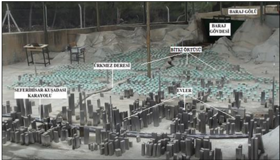
Şekil 3.5 Bitki örtülü durumda fiziksel modelin tamamlanmış hali (Kişisel arşiv, 2015)
