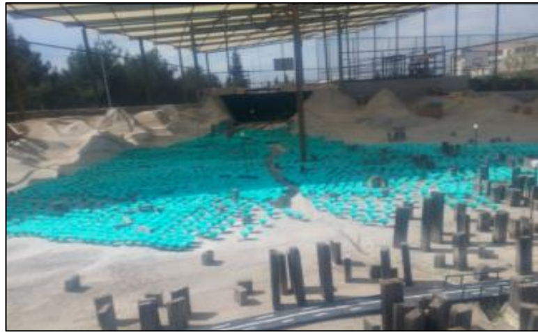
Şekil 4.11 Fiziksel modelin yoğun bitki örtülü durumdaki güncel hali (Oğuzhan ve Aksoy, 2020)
