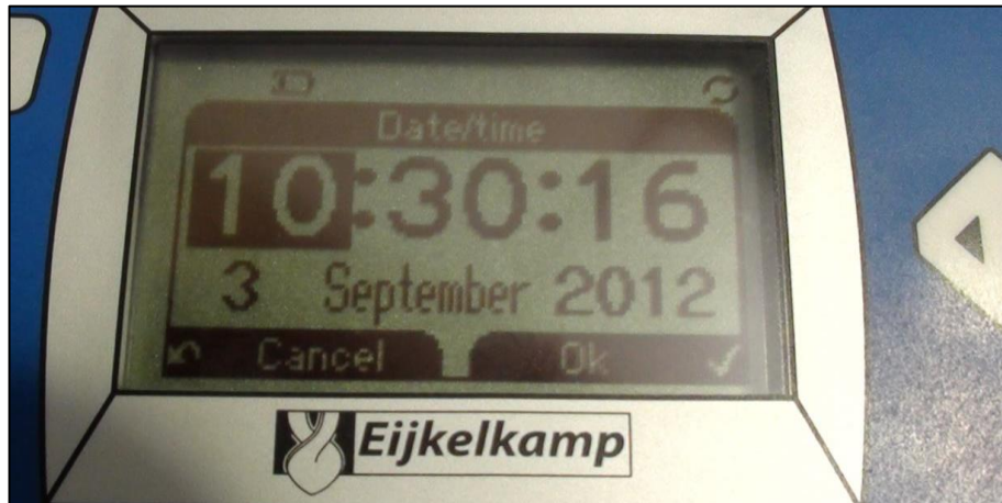
Şekil EK 2.3 Seviye ölçümünde kullanılan kontrol cihazı ile ölçüme başlanılması istenen tarih ve saat bilgilerinin ayarlanması (Kişisel arşiv, 2013)
