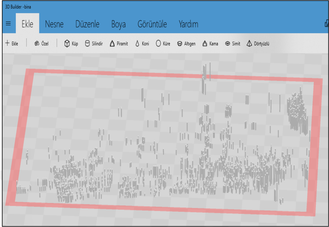
Şekil 5.15 Barajın mansap bölgesindeki yerleşim alanında bulunan evlerin Stl formatındaki 3 boyutlu modeli
