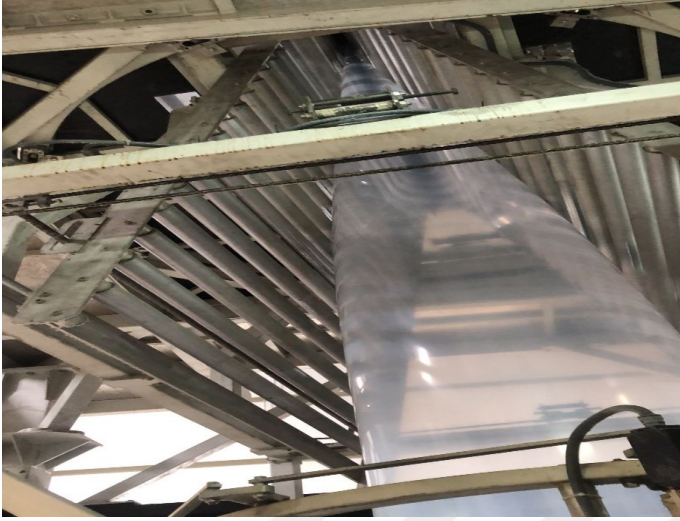
Resim 3.27. Ön germe silindiri
