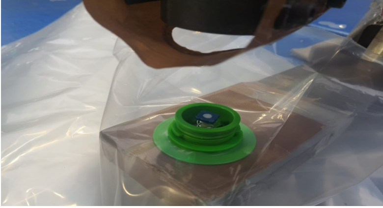
Resim 3.35. Filme valfin kaynatılma işlemi
