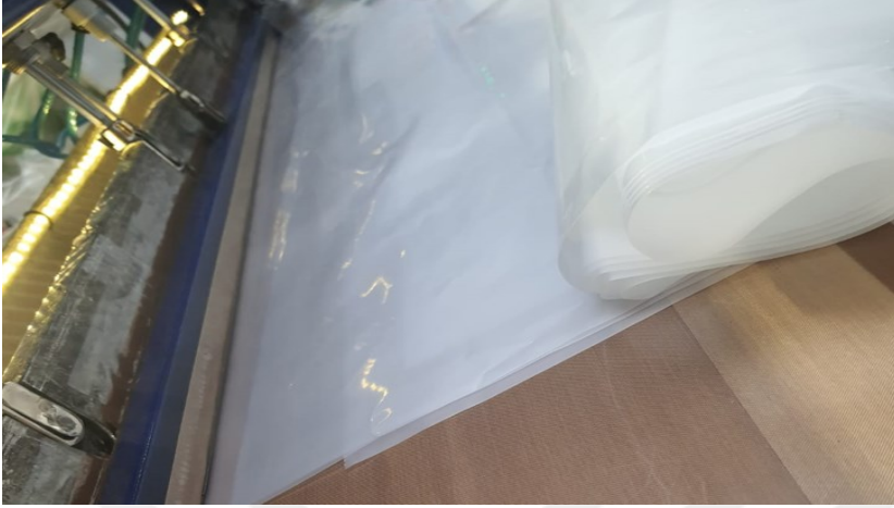
Resim 3.37. Film kenarının kaynatılma işlemi
