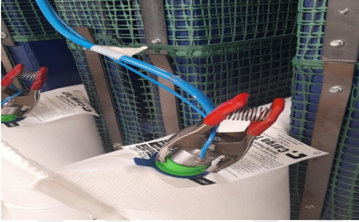
Resim 4.5. Yastığı hava ile şişirme işlemi
