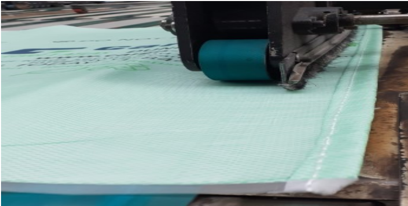
Resim 3.41. Kumaş kenarlarının dikilme işlemi
