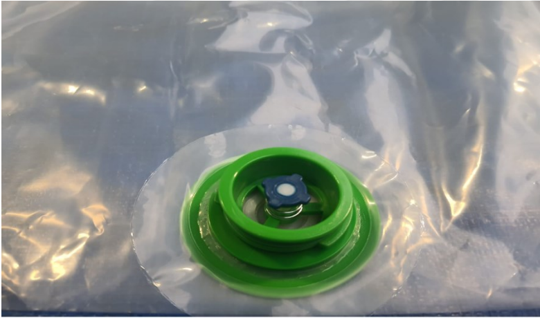
Resim 3.36. Valfi kaynatılmış film
