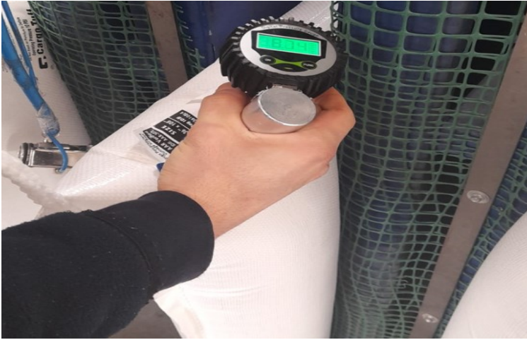
Resim 4.6. Şişirilen yastıktan ölçüm sonucu basınç değeri alma işlemi
