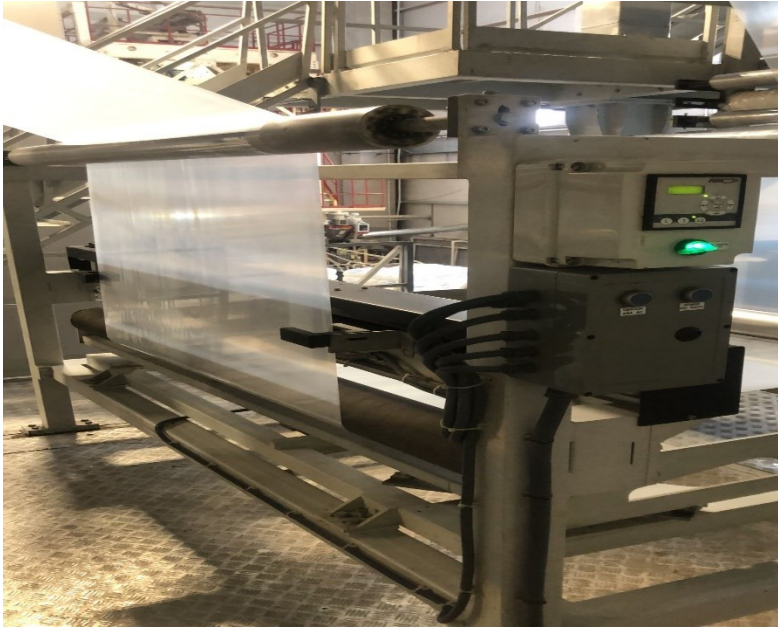
Resim 3.26. Kenar kontrol ünitesi
