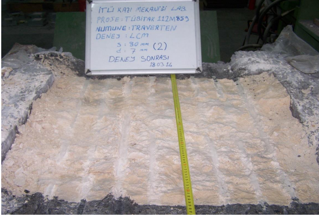
Şekil 4.40 : Traverten numunesi üzerinde s = 80 mm, d = 7 mm şartlarında yardımcı yapılan kazı deneyi sonrası görüntüsü.
