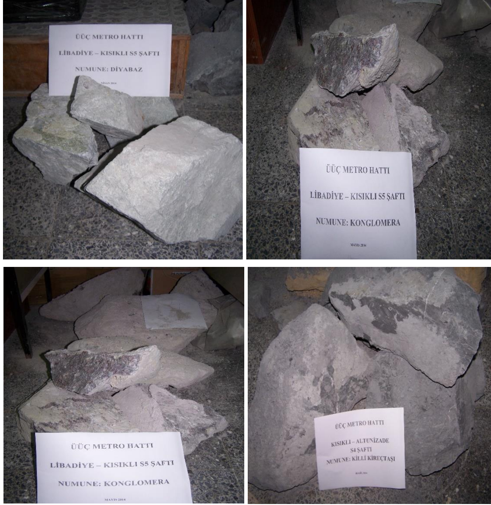
Şekil 4.70 : PLCM deneylerinde kullanılmak üzere araziden temin edilen blok numuneler.
