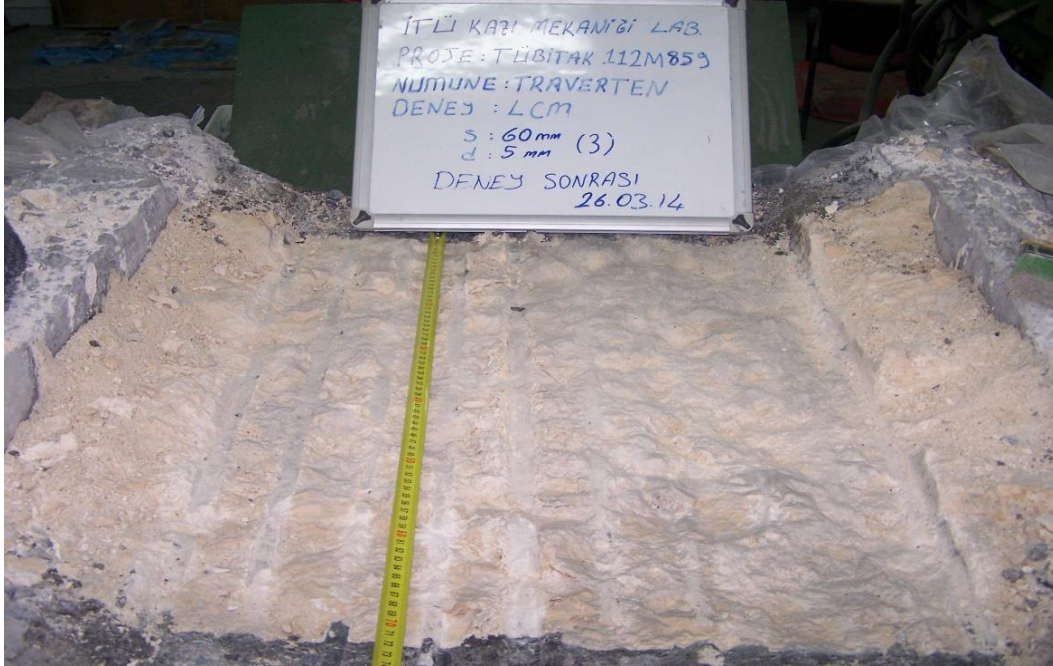
Şekil 4.41 : Traverten numunesi üzerinde s = 60 mm, d = 5 mm şartlarında yardımcı yapılan kazı deneyi sonrası görüntüsü.
