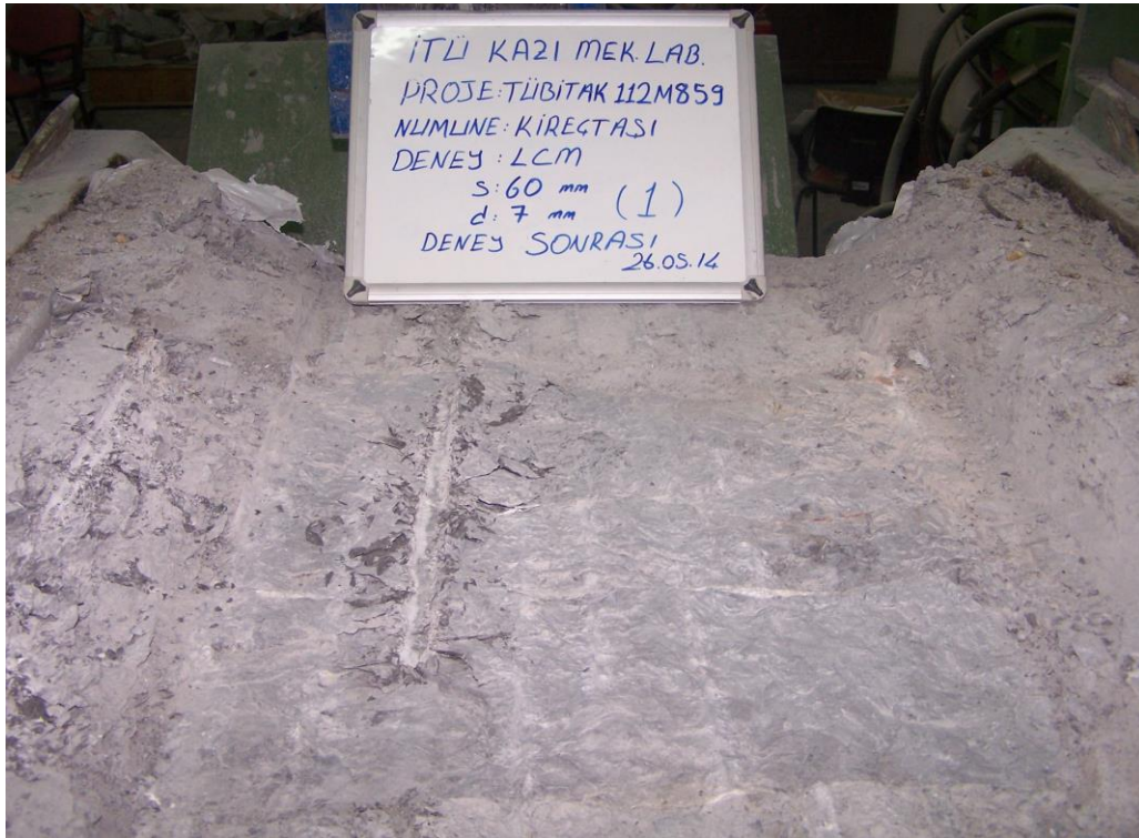
řekil 4.55 : Kiretařı numunesi zerinde s = 60 mm, d = 7 mm řartlarında yardımcı yapılan kazı deneyi sonrası grntř.
