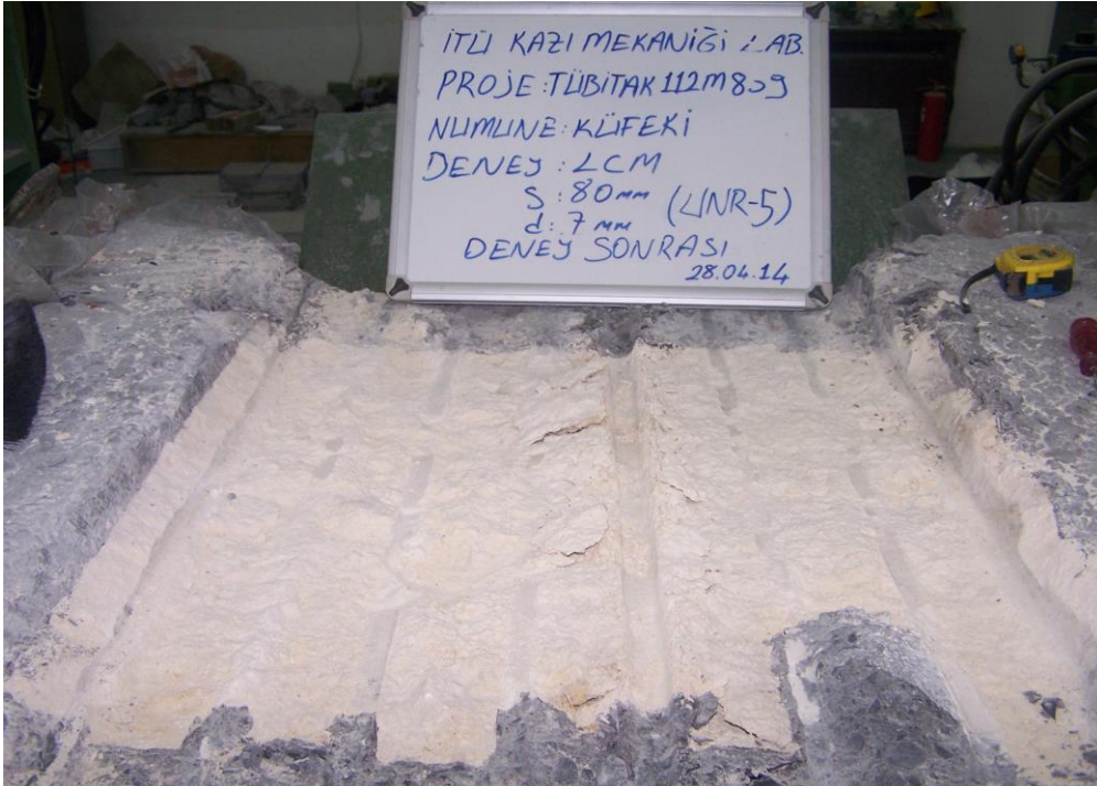
Şekil 4.48 : Küşeki kireçtaşı numunesi üzerinde d = 7 mm şartlarında yardımcı yapılan kazı deneyi sonrası görüntüsü.
