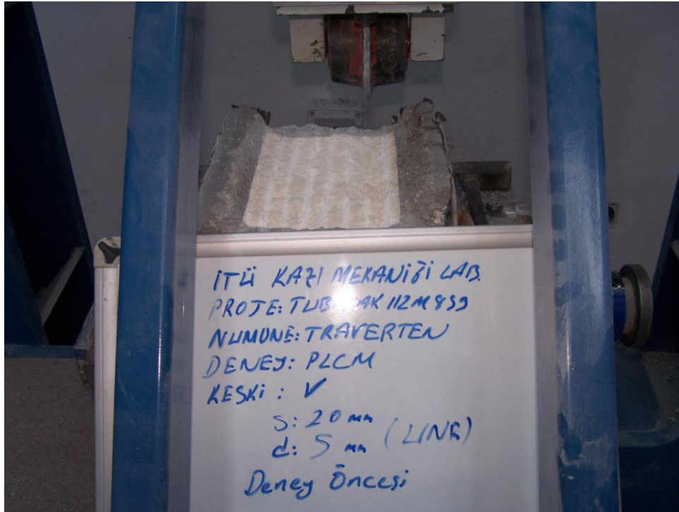
Şekil 4.86 : Traverten numunesi üzerinde d =5 mm şartlarında yardımsız yapılan PLCM kazı deney öncesi görüntüsü.
