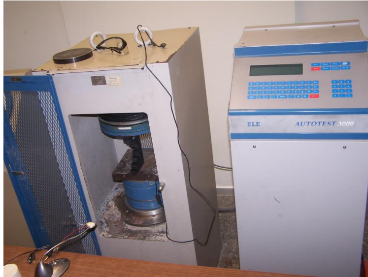
Şekil 4.5 : Dolaylı (Brazilian) çekme dayanımı değerlerinin tayini için kullanılan hidrolik pres.
