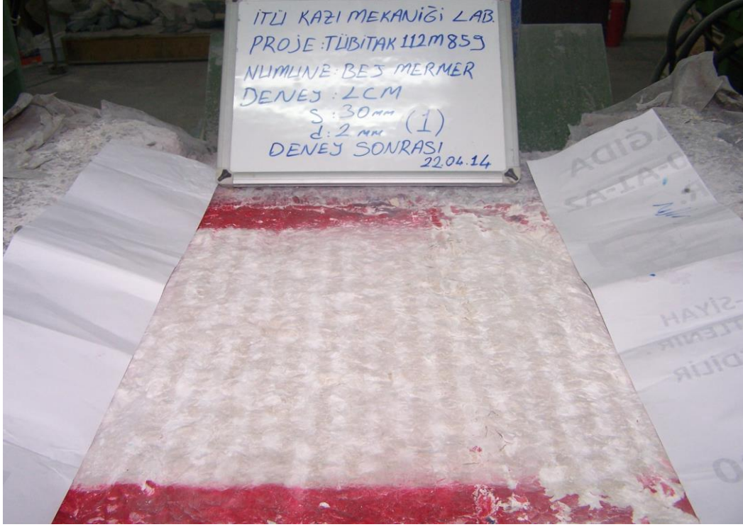
Şekil 4.31 : Bej mermer numunesi üzerinde s = 30 mm, d = 2 mm şartlarında yardımcı yapılan kazı deneyi sonrası görüntüsü.
