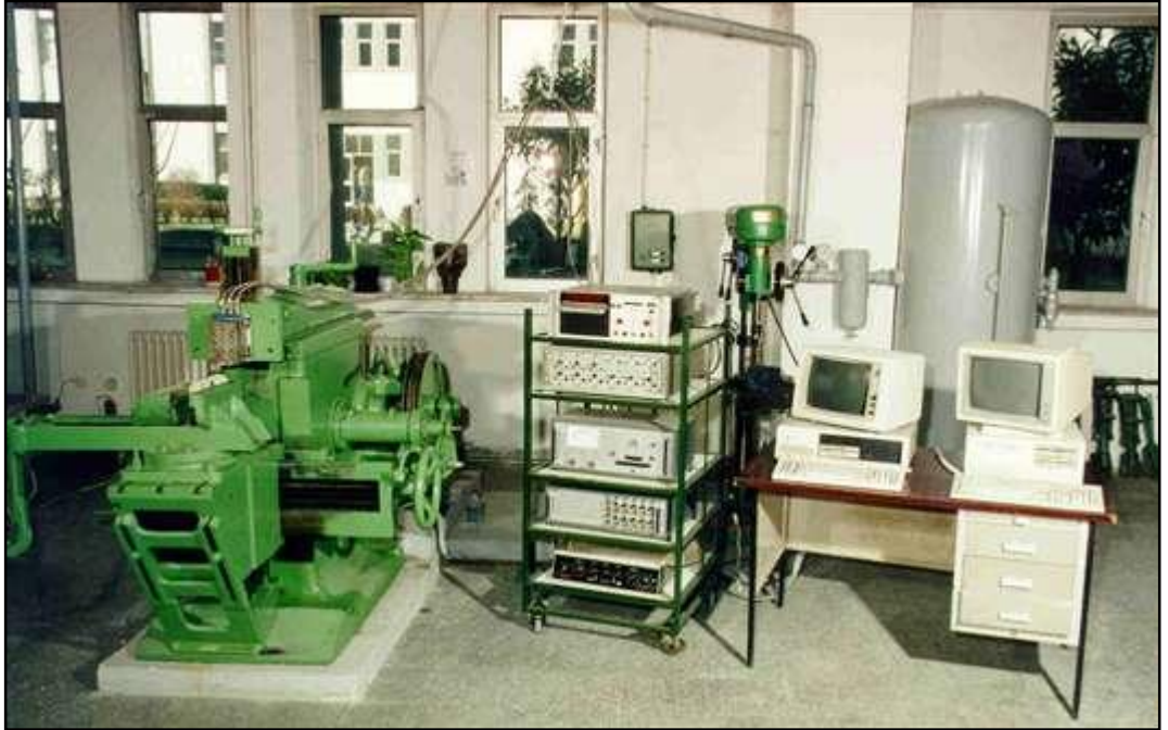
Şekil 3.1 : İTÜ Maden Mühendisliği Bölümü Kazı Mekanizasyonu ve Teknolojileri Laboratuvarında bulunan küçük boyutlu kazı deney seti.
