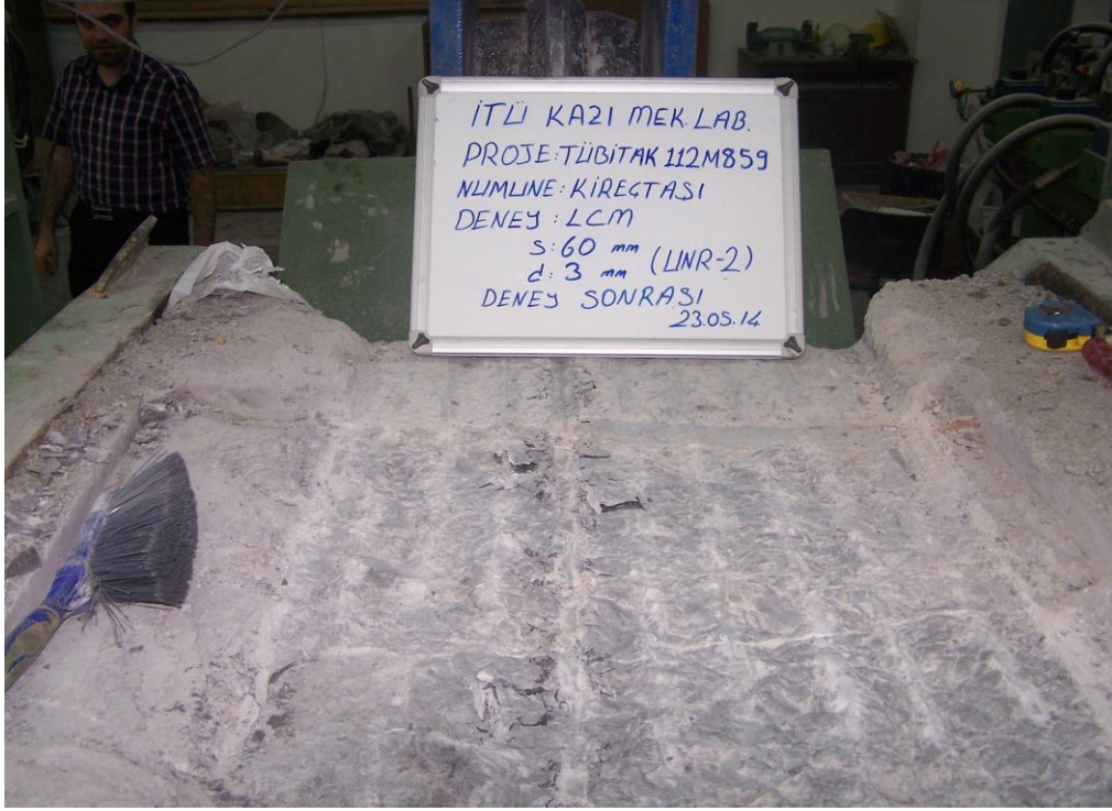
řekil 4.54 : Kiretařı numunesi zerinde d = 3 mm řartlarında yardımsız yapılan kazı deneyi sonrası grntř.
