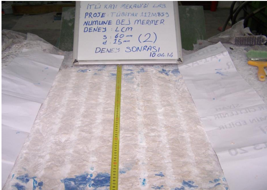
Şekil 4.30: Bej mermer numunesi üzerinde s = 60 mm, d = 1.5 mm şartlarında yardımcı yapılan kazı deney sonrası görüntüsü.
