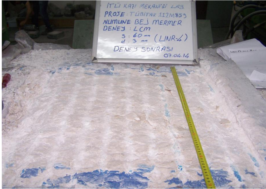
Şekil 4.29 : Bej mermer numunesi üzerinde s = 60 mm, d = 3 mm şartlarında yardımsız yapılan kazı deney sonrası görüntüsü.
