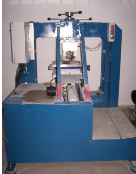
Şekil 4.68 : İTÜ Maden Mühendisliği Bölümü Kazı Mekanizasyonu ve Teknolojileri Laboratuvarında yeni geliştirilen taşınabilir doğrusal kazı deney seti.
