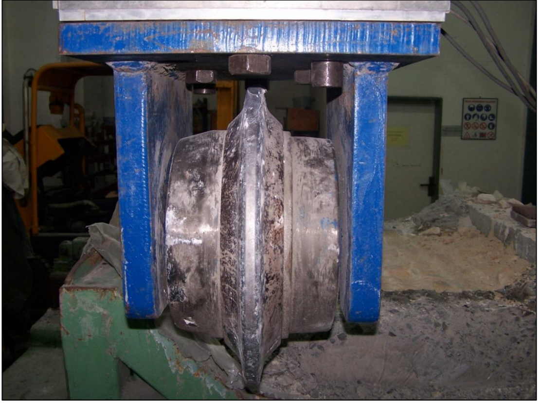
Şekil 4.24 : LCM kaya kesme deneylerinde kullanılan 432 mm çaplı CCS tip disk keski.
