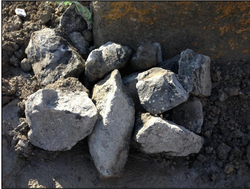
Şekil 4.3 : Çarşı – Libadiye arası (S6 shaftı) kazı hattından alınan kireçtaşı örnekleri.
