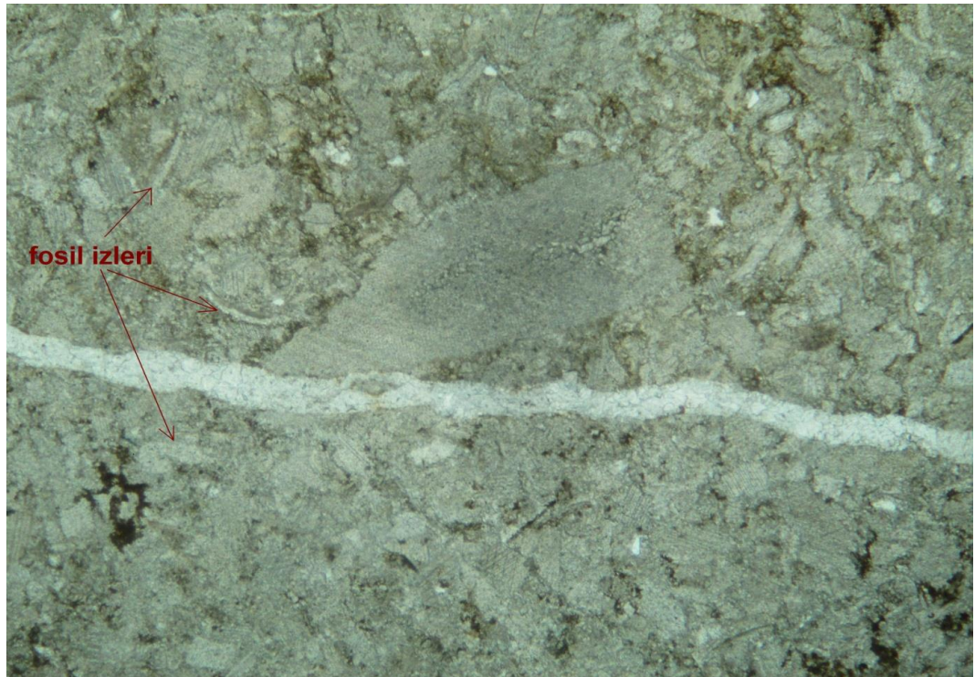
Şekil 4.18 : Altere kireçtaşı örneğinin polarizan mikroskop altında çift nikol (yukarıda) ve tek nikol (aşağıda) görüntüleri. k: kalsit, mk: mikritik kalsit, lm: limonit. Kayaç ikincil kalsit dolgulu mikro çatlaklar içerir.
