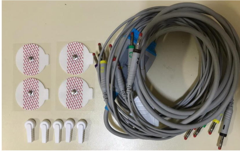
Şekil 3.16 Ölçüm için kullanılan kablo ve elektrotlar
