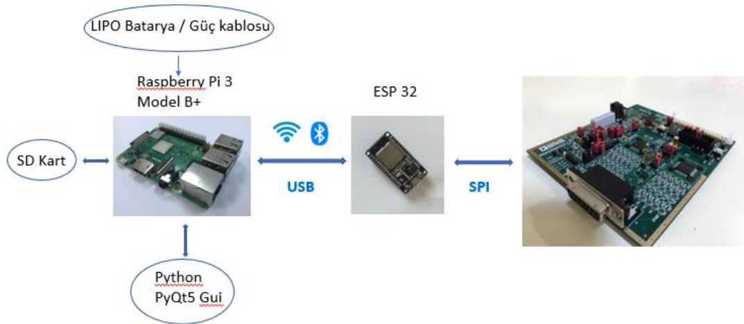
Şekil 3.18 Sistemin blok şeması
