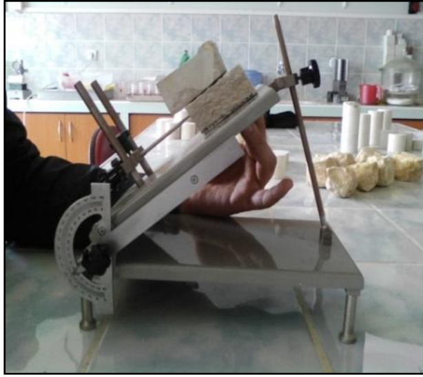
Şekil 22. Doğal sürtünme açısını belirlemede kullanılan basit tilt test aleti
