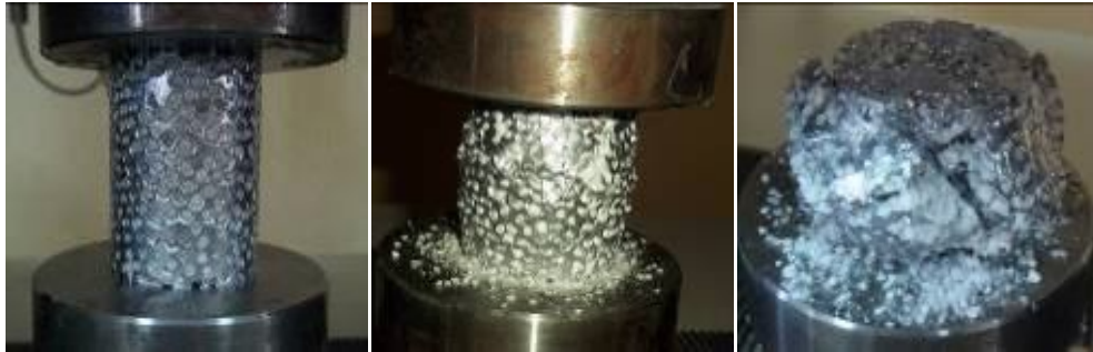
Resim 5.19 Basma testi sırasında ve sonrasındaki Al-12Si içerikli numune
