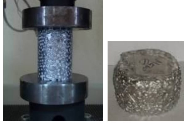
Resim 5.18 Basma testi sırasında ve sonrasındaki Al esaslı numune
