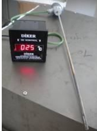
Resim 4.8 Pota sıcaklığının ölçülmesinde kullanılan cihaz
