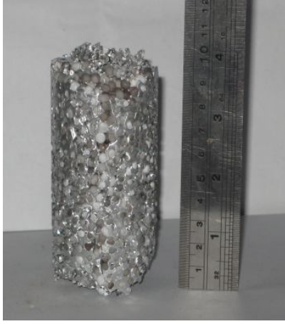
Resim 5.15 Kalıptan ilk çıkan numunenin şekli ve deneye hazır hale getirilmiş numune
