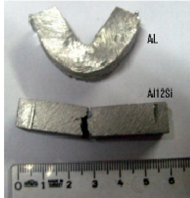
Resim 5.20 Al12Si ve Al parçalarının darbe testi sonucundaki görüntüleri
