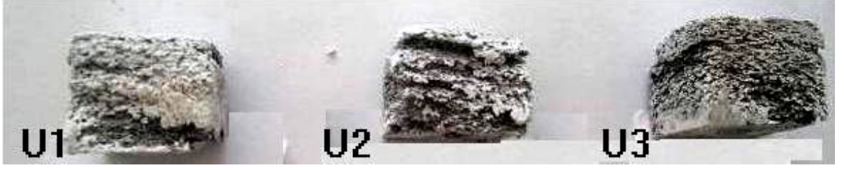
Resim 5.1. U serisindeki numunelerin görüntüleri ve katmanlaşmalar.
