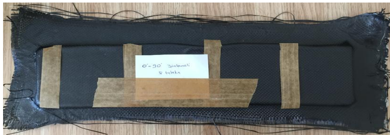
Resim 3.34 C_2^8 oryantasyonlu darbe test numunesi.
