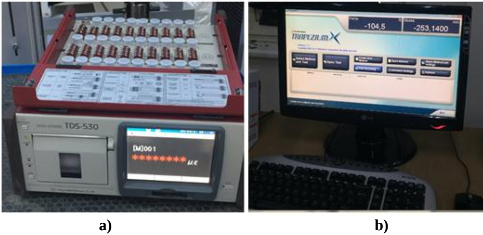
Resim 3.29 Çekme testinde kullanılan a) Data logger b) bilgisayar ara yüz yazılımı.
