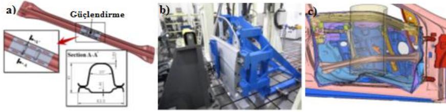
Şekil 2.11 a) Güçlendirilmiş çelik kiriş b) FMVSS 214'e standartlarına göre test c) sonlu elemanlar yöntemi ile analizin gösterimi (Lee vd. 2015).
