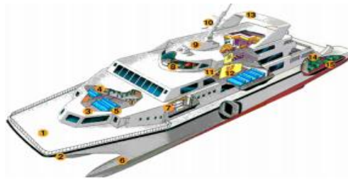
Resim 1.7 Hızlı feribotta sandviç yapının kullanıldığı kısımlar (Yiğit 2010).
