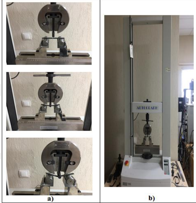
Resim 3.24 Hazırlanan test numunelerinin a) Üç nokta eğme testi b) AUTOGRAPH cihazı.
