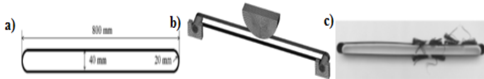
Şekil 2.4 CFRP koruma band'ın; a) ölçüleri b) darbe testi c) darbe sonrası oluşan hasar gösterimi (Aoki vd. 2009).
