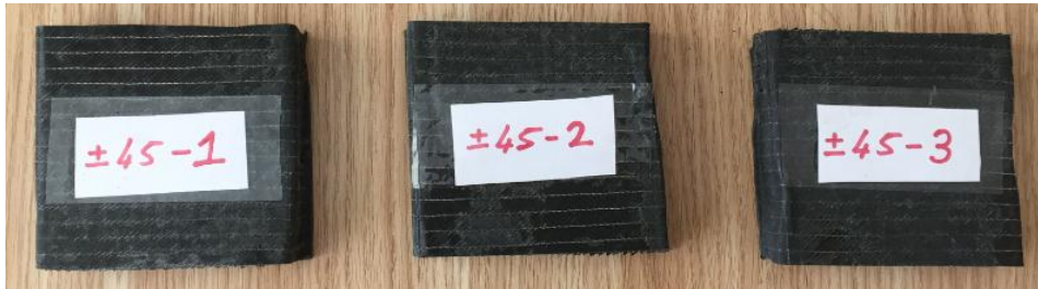
Resim 3.37 C_3^8 oryantasyonlu numunenin standart ölçülere göre kesilmesi.
