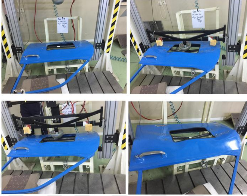
Resim 4.13 O profil tabakalı karbon fiber kirişe serbest düşme (3 m).
