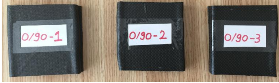
Resim 3.35 C_2^8 Oryantasyonlu numunenin standart ölçülere göre kesilmesi.
