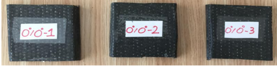
Resim 3.33 C_1^8 oryantasyonlu numunenin standart ölçülere göre kesilmesi.
