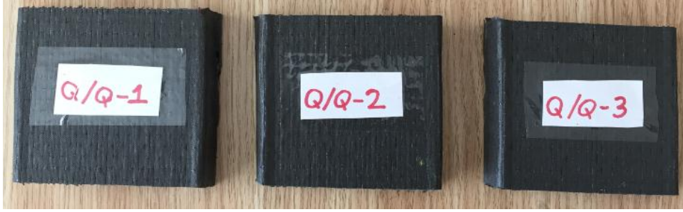
Resim 3.39 C_4^8 oryantasyonlu numunenin standart ölçülere göre kesilmesi.
