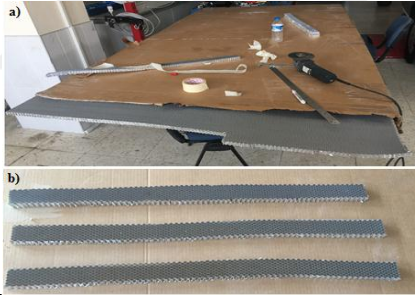
Resim 3.42 Alüminyum bal petek yapısının a) Al tabaka b) İstenilen ebatlarda kesim işlemi (800 x 45 x 1.8 mm).
