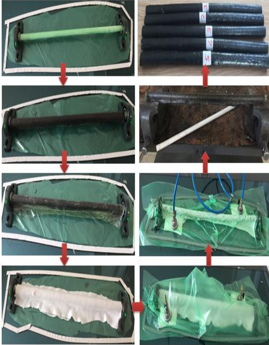
Resim 3.46 O profil karbon fiber kiriş üretim aşamaları.
