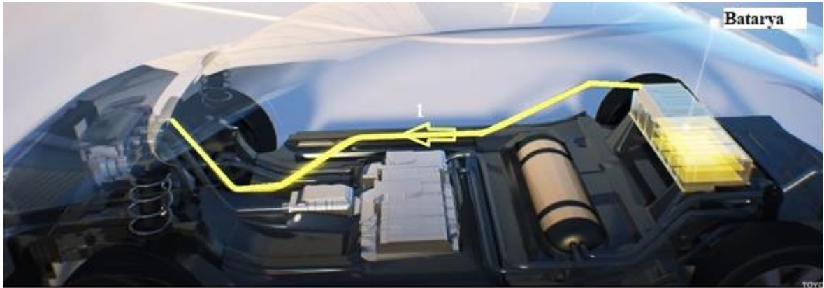
Şekil 5.23. Bataryadan elektrik motoruna doğru besleme hattı (Anonim, 2020)
