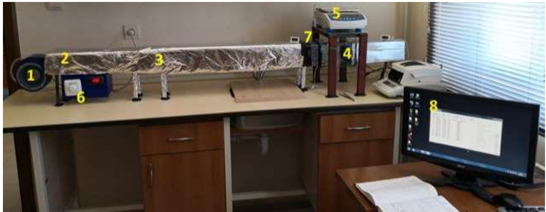
Şekil 4.2. Tünel tipi kurutucu görüntüsü. (1-Fan 2-Rezistans bölgesi 3-Hidro dinamik geçiş bölgesi 4-Terazi Bölgesi 5-Terazi 6-Kontrol paneli 7- Dijital Termometre 8-Bilgisayar)
