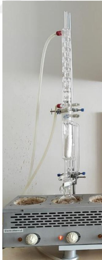
Şekil 4.3. Soxhlet deney düzeneği
