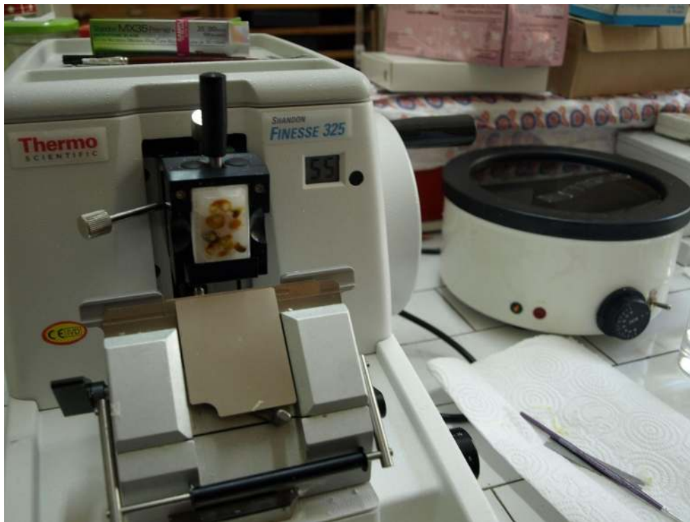
Resim 4.2. Mikrotomla kesit alınması
