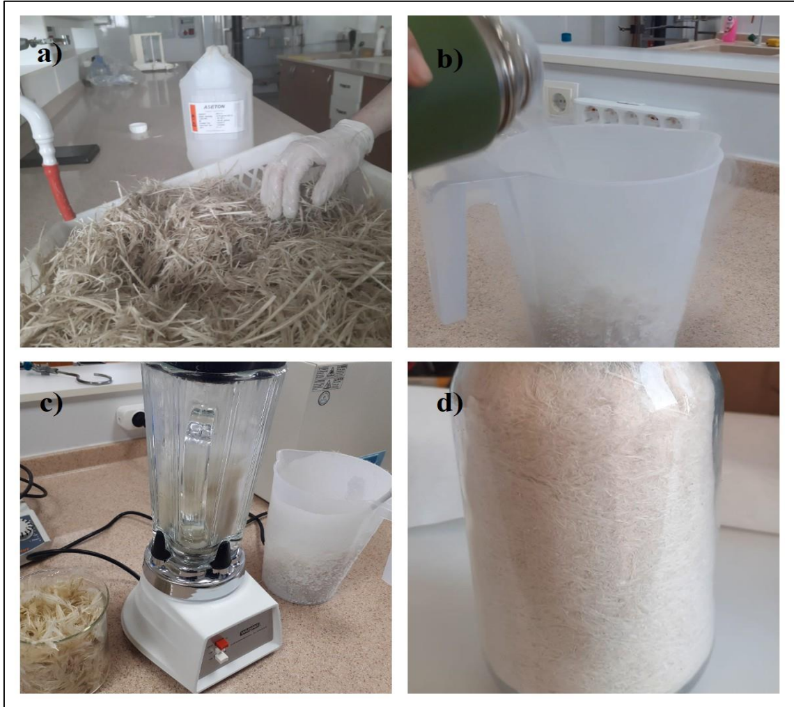
Şekil 3.2 a) Yapışkan madde ve kirlerden arındırma işlemi b) Sıvı nitrojen ilavesi c) Blender ile parçalama işlemi d) Ön işlem sonucu elde edilen tavuk tüyü lifleri.
