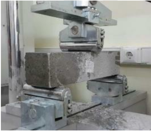
Şekil 2.7. Eğilme basınç deneyi
