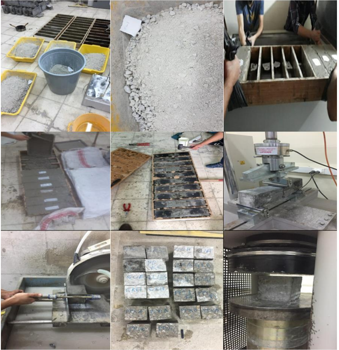
Şekil 2.5. Lifli beton yapım aşamaları
