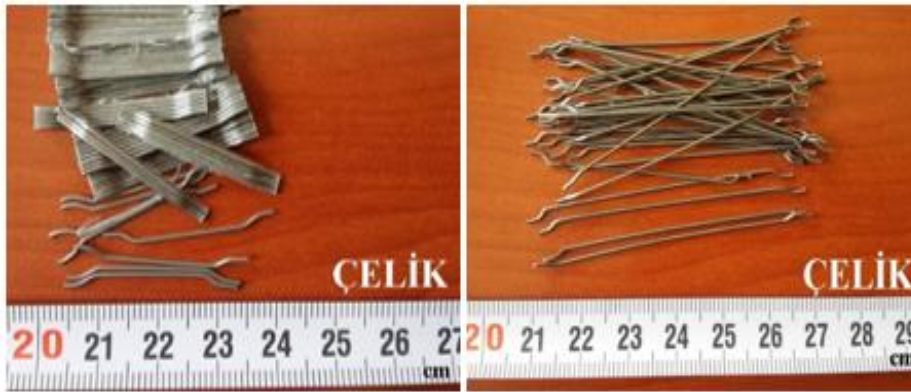
Şekil 2.3. Betonda kullanılan kısa ve uzun çelik lifler
