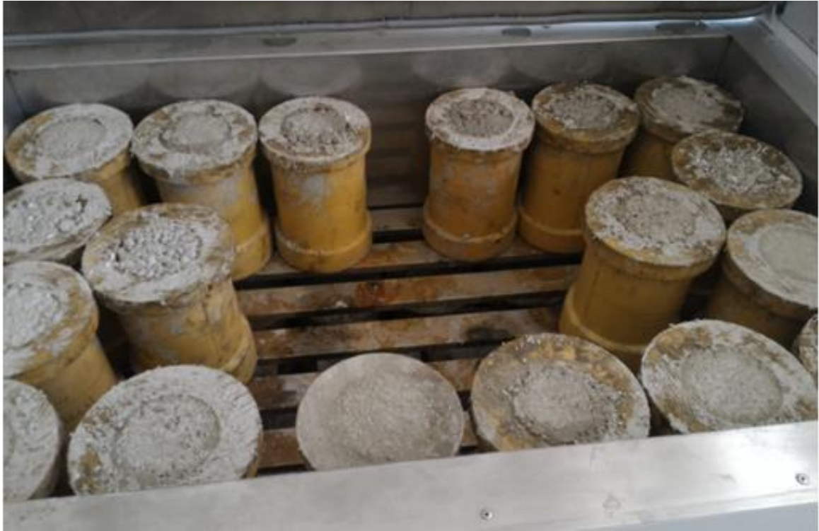
Şekil 2.3. Dona maruz bırakılan beton örnekler
