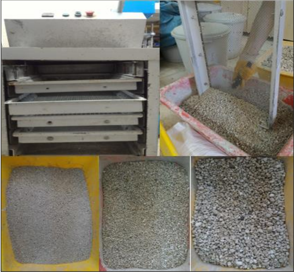
Şekil 2.1. Pomza agregalarının eleme işlemi
