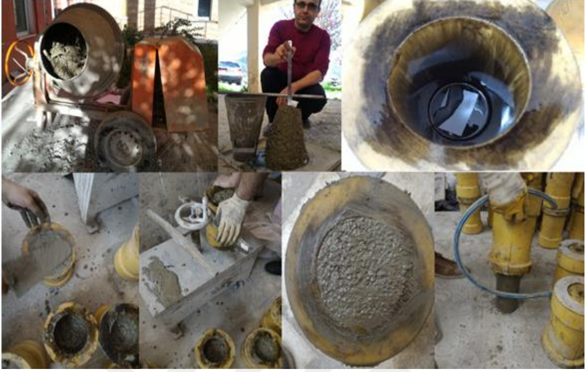
Şekil 2.2. Beton örneklerin üretim aşamaları
