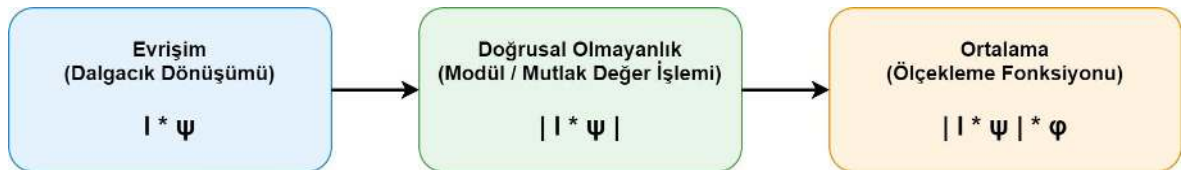
Şekil 2.37: Dalgacık Saçılım Ağlarında saçılım katsayılarının elde edilmesinde kullanılan temel işlemler.
