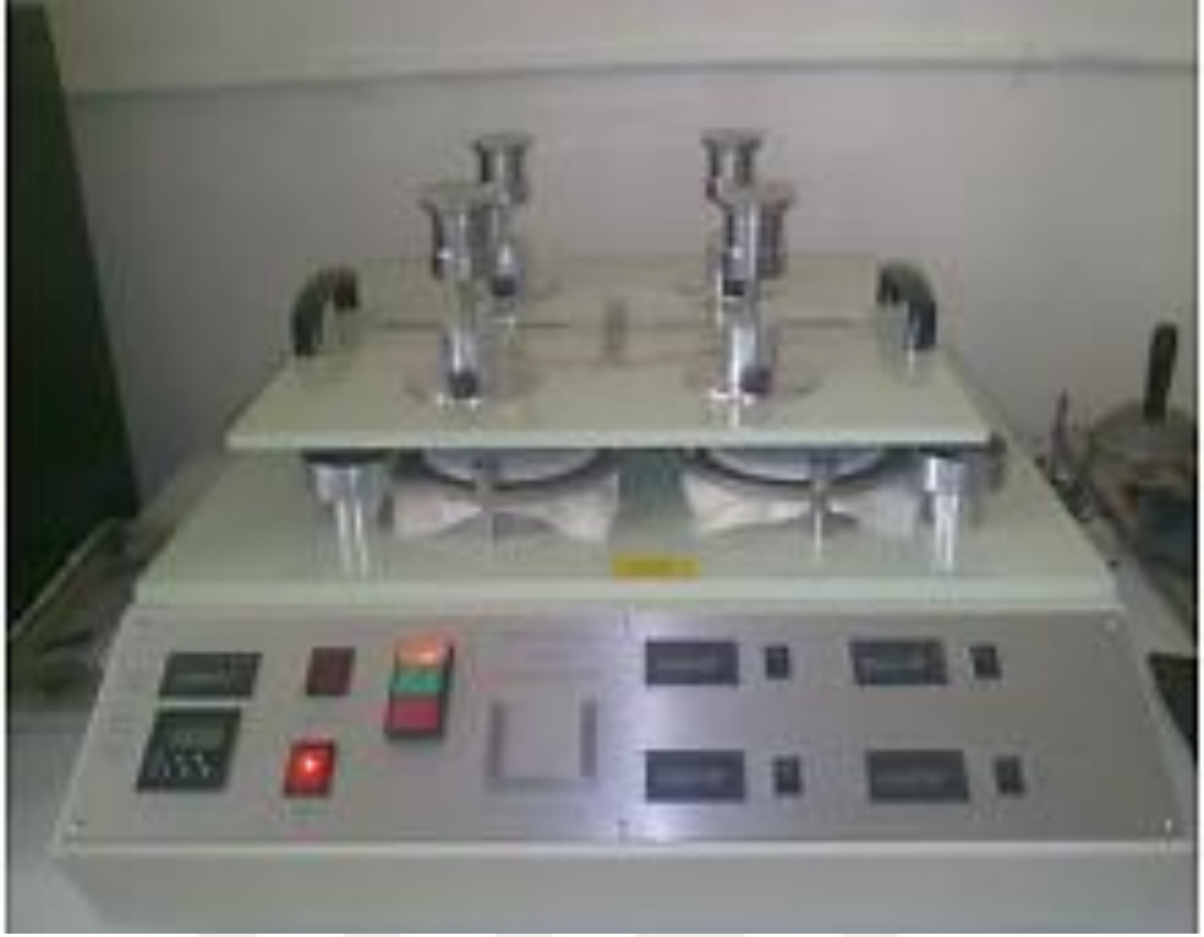
Şekil 3.7. Martindale Abrazyon cihazı
