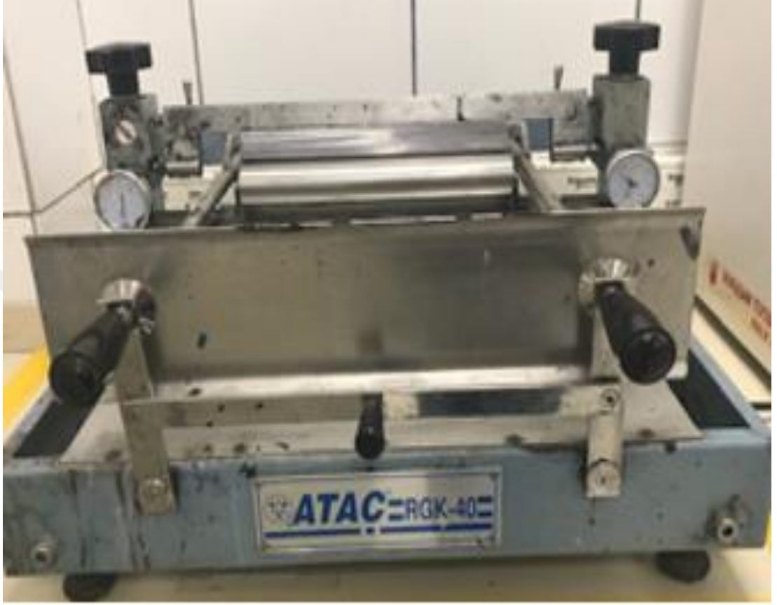
Şekil 3.5. Atac-Rgk40 Laboratuar tipi rakle
