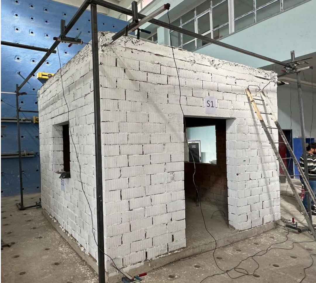
Şekil 4.21 Donatısız deney numunesinin beyaz renk ile boyanmış görünümü
