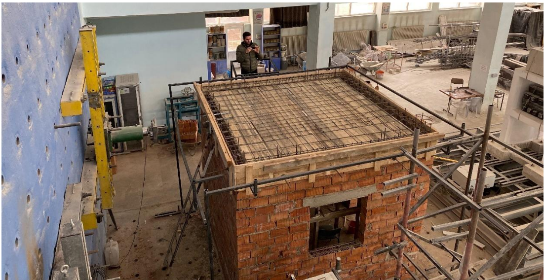
Şekil 4.28 Beton dökümü öncesi hazırlanmış donatılı yığma deneyi numunesi
