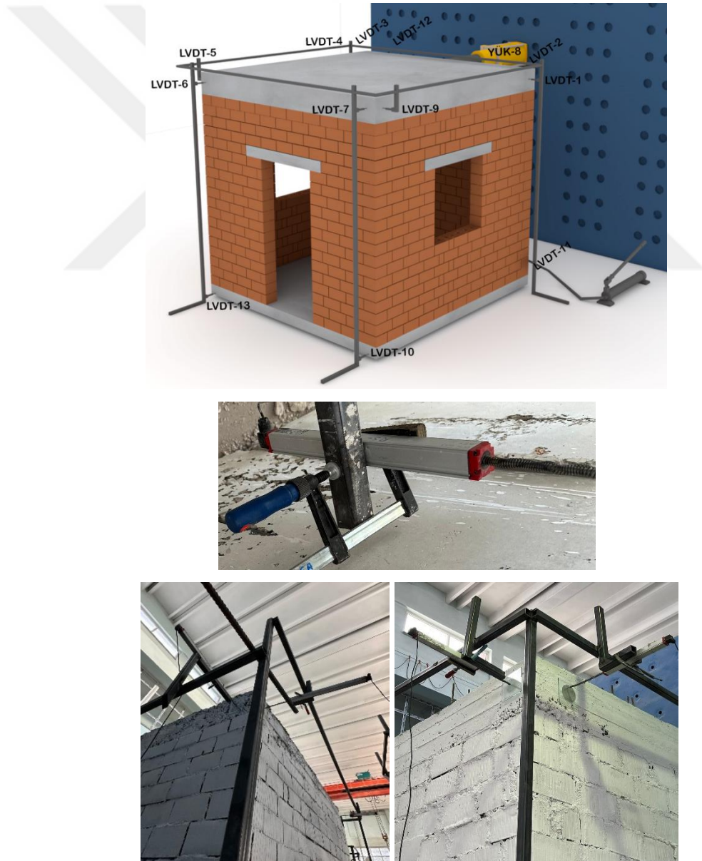
Şekil 4.33 Deneylerde kullanılan potansiyometrik cetvel ve yük hücresi
