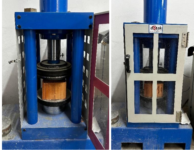
Şekil 4.5 Tuğla numunelerinin basınç dayanımı testi
