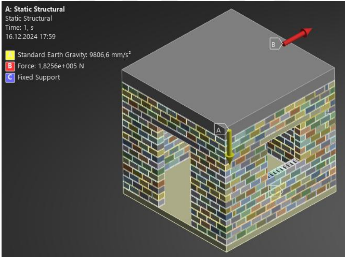
Şekil 4.46 Numunelerin statik analizi öncesi verilerin girilmesi
