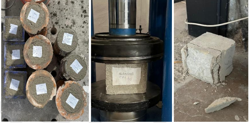
Şekil 4.8 Beton numunelerinin basınç dayanımı testleri
