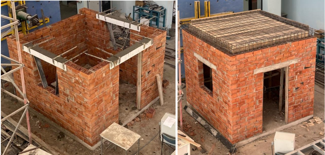
Şekil 4.15 Donatısız yığma bina lento üretimi öncesi ve sonrası.
