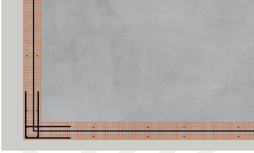
Şekil 4.24 Donatılı yığma bina köşe donatı planı görseli
