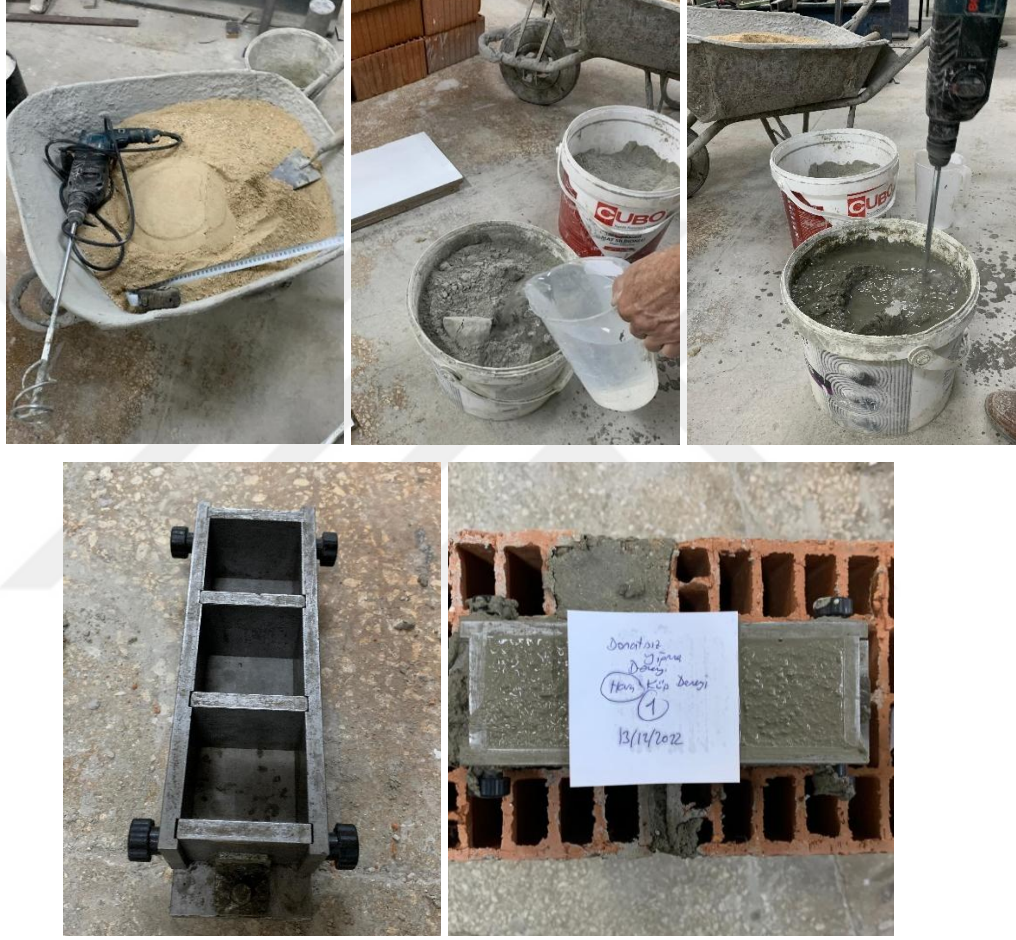
Şekil 4.6 Yığma tuğla harç malzemelerinin hazırlanışı
