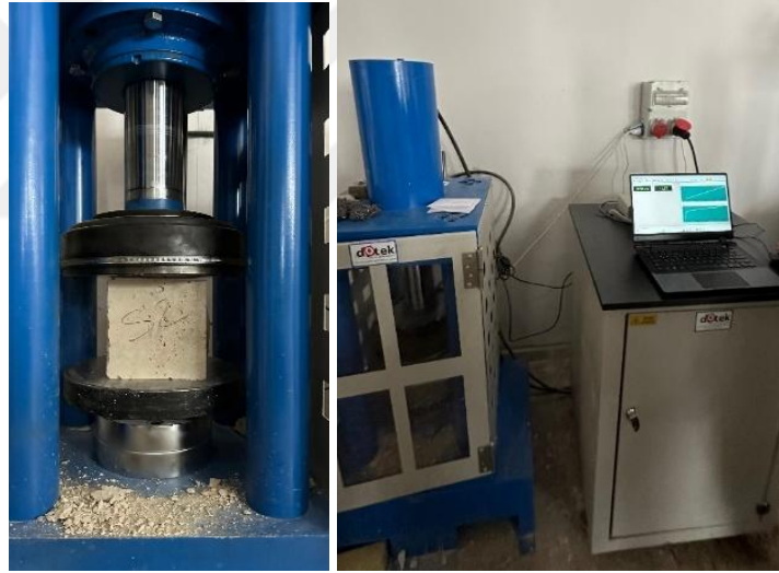
Şekil 4.7 Harç numunelerinin basınç dayanımı testleri
