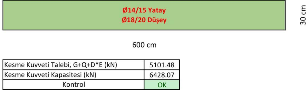
Şekil 103. Aşama-1 ZB zemin sınıfı için bodrum perdesi kesme hesap sonuçları
