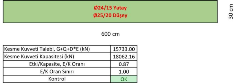
Şekil 218. Aşama-3 ZC için bodrum perdesi kesme kontrolü
