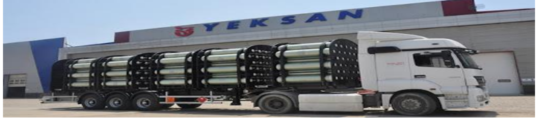
Şekil 2.12. 165’lik Taşıyıcı Treyler (Çok elemanlı gaz konteyneri yüklenmiş bir çekici)
