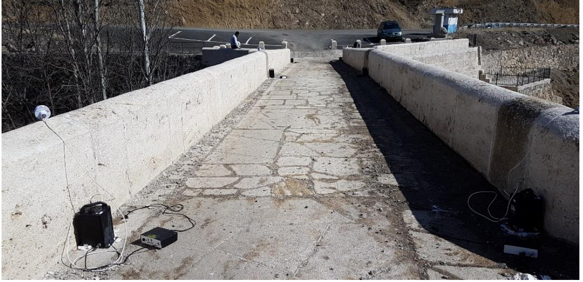
Şekil 3.33. Pehlivanlı Köprüsü restorasyonundan 2 yıl sonra gerçekleştirilen operasyonel modal analiz uygulamasından bir görüntü.
