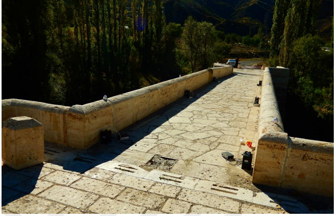
Şekil 3.32. Kireçli Köprüsü restorasyon sonrası operasyonel modal analiz çalışmasından bir görüntü (Okuyucu vd 2016).
