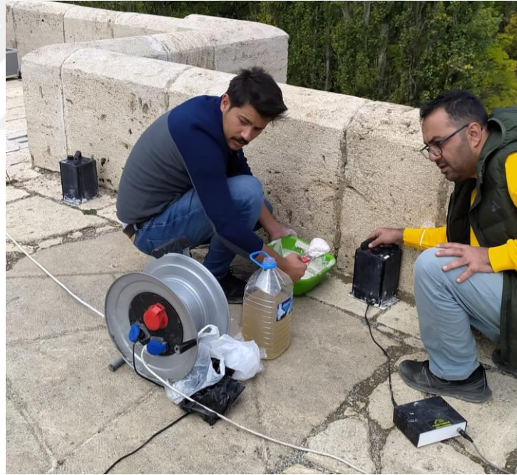
Şekil 3.16. Üç eksenli ivmeölçerlerin köprü üzerine sabitlenmesi
