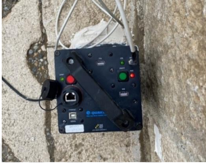
Şekil 3.17. Senkronize edilmiş ultra hassas üç eksenli ivmeölçer
