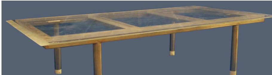
Şekil 3.8. İstenilen Reynolds Sayısında Derin Su Akışı Oluşturmak İçin Kanala Yerleştirilen Platformun Şematik Gösterimi.
