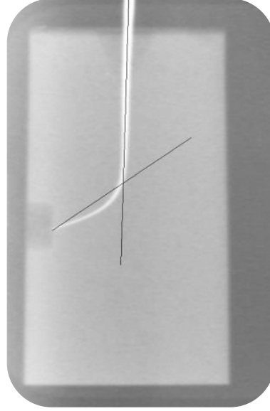
Şekil 3.2. L-şekilli kanalların kurvatür açılarının hesaplanması
