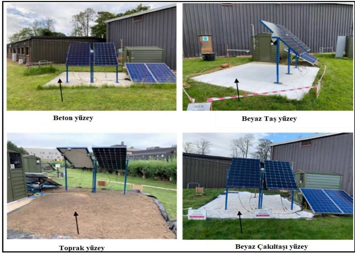
Şekil 4.13. Tek yönlü ve çift yönlü fotovoltaik panellerin beton, beyaz taş, toprak ve beyaz çakıl taşı yüzeylerde performansının incelendiği deney düzeneği
