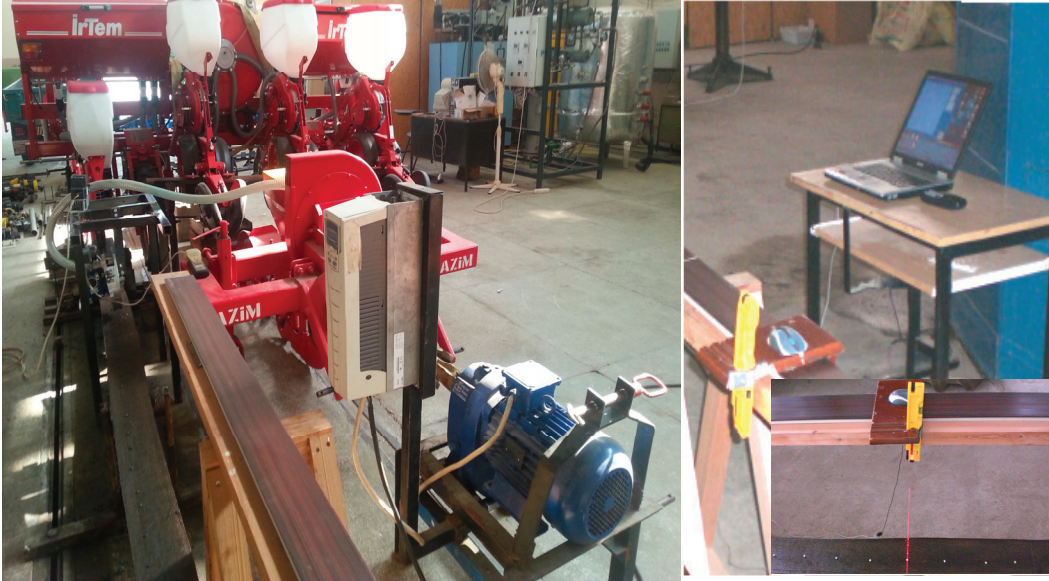
Şekil 3.7. Yapışkan bant deneme düzeneği ve lazerli sıra üzeri mesafe ölçüm düzeneği
