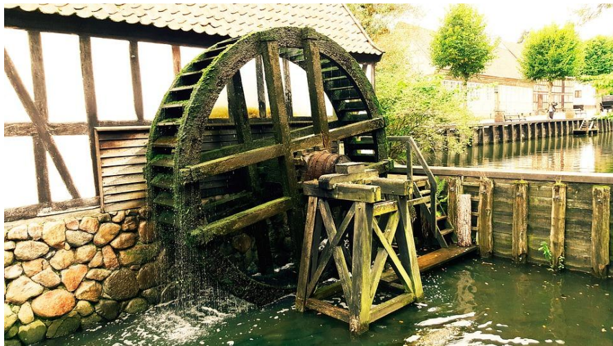
Şekil 1.2. Su değirmeni pompalama sistemi - Naûra (Noria) [2]
