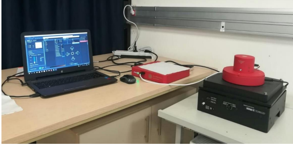
Şekil 3.7. Laboratuvarımızda kullanılan atomik kuvvet mikroskobu cihazı
