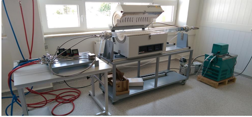
Şekil 2.2. Laboratuvarımızda kullanılan KBB sistemi
