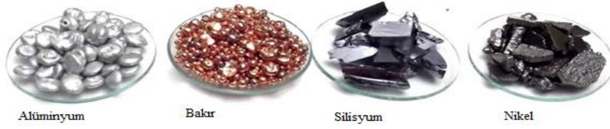
Şekil 3.1. Cu-Ni ve Al-Si alaşımlarını oluşturan bileşenler
