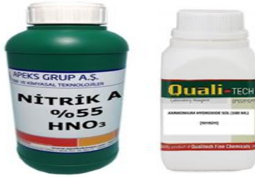
Şekil 3.9. Dağlama işleminde kullanılan \text{HNO}_3 ve \text{NH}_4\text{OH} kimyasal malzemeler
