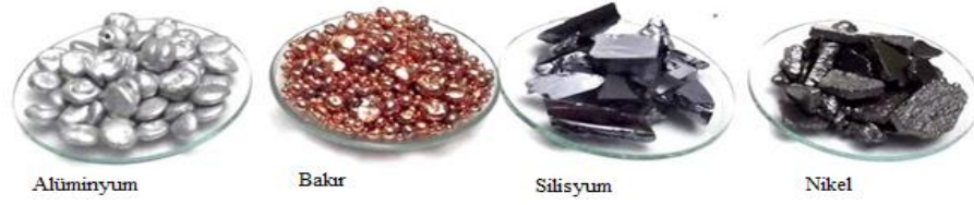
Şekil 3.1. Cu-Ni ve Al-Si alaşımlarını oluşturan bileşenler
