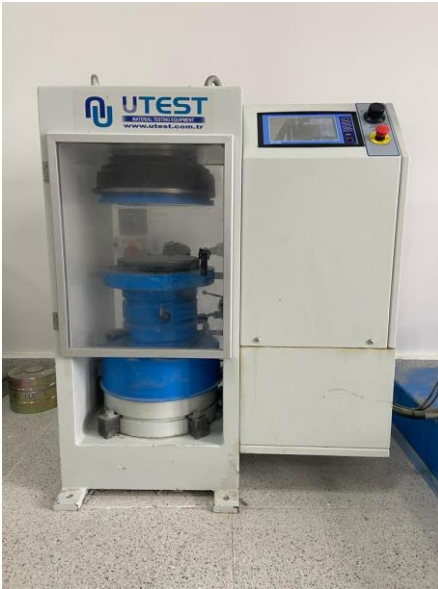
Resim 2.5. Otomatik basınç dayanım deney presi (UTC-4231)
