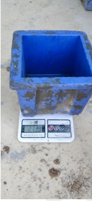
Resim 2.8. Beton kalıbı ve ölçüm yapılan hassas terazi
