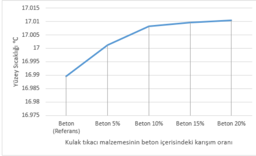
Şekil 3.5. Kulak tıkacı kullanılan beton numunelerin yüzey sıcaklığı değerleri
