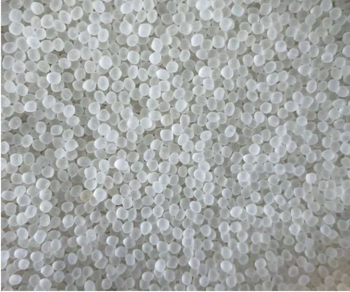
Resim 2.1. Kulak tıkacı hammaddesi (Poliolefin bazlı termoplastik elastomer (SEBS))
