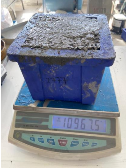
Resim 2.2. Beton numunenin kalıp içerisinde görünümü
