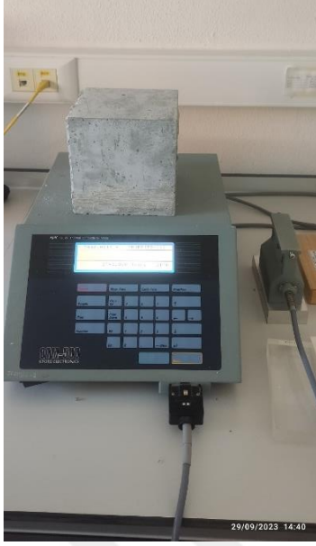
Resim 2.7. Beton numunenin QTM 500 cihazı ile ısı iletkenlik değerin ölçümü
