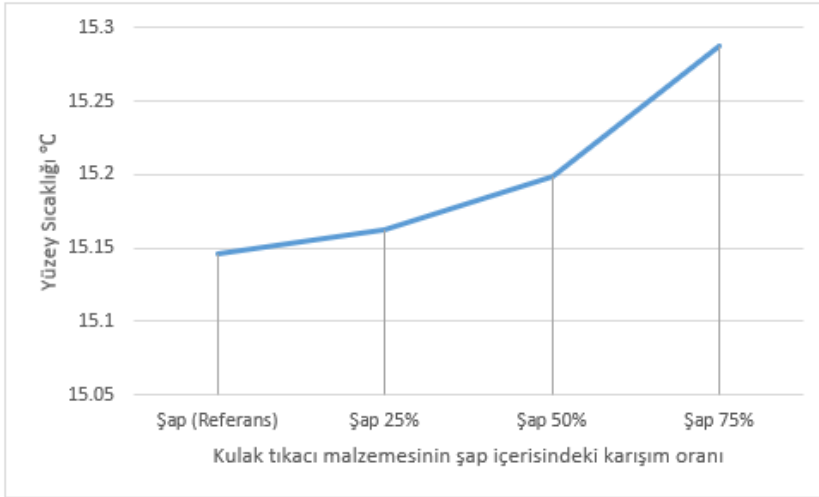
Şekil 3.7. Kulak tıkacı kullanılan şap numunelerinin yüzey sıcaklığı değerleri
