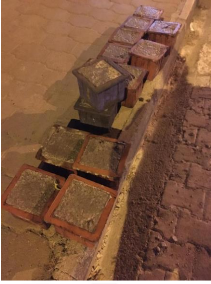
Resim 2.4. Isıl iletkenlik katsayısı ve basınç dayanım testleri için dökülen beton numuneler
