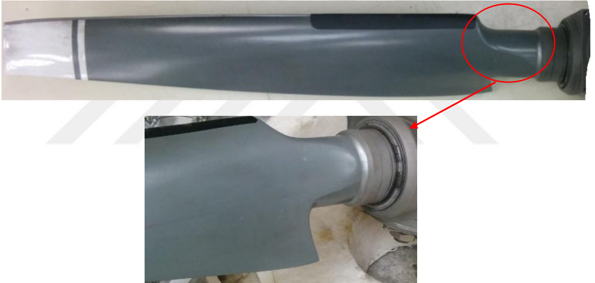
Şekil 2.6. 1.8 metre çapındaki pervane pali ve kök (shank) formu
