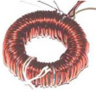
Şekil 4.6 Sarımı yapılmış toroidal nüveli yapı (Soong 2008).
