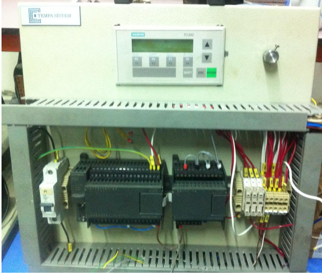
Şekil 4.5 S7-200 PLC modülleri ve ekranı
