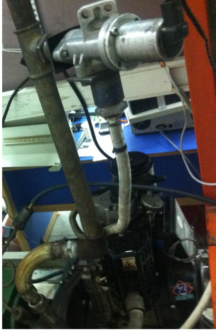
Şekil 4.9 Motora bağlanan EGR valfi
