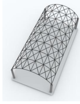
Şekil 3.24 Çift çaprazlı silindirik kabuk
