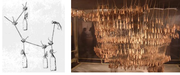
Şekil 3.7 Gaudi'nin çekme deneyi ve asılı zincir modeli [22]
