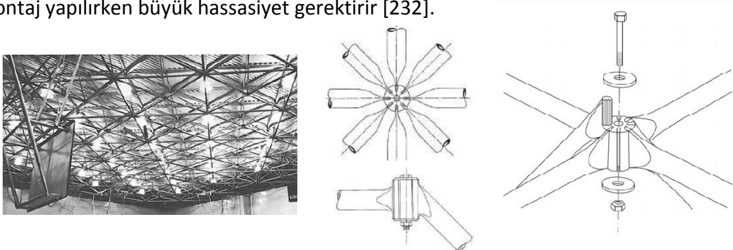
Şekil EK-1.33 Triodetic birleşim detayı [233], [237]
