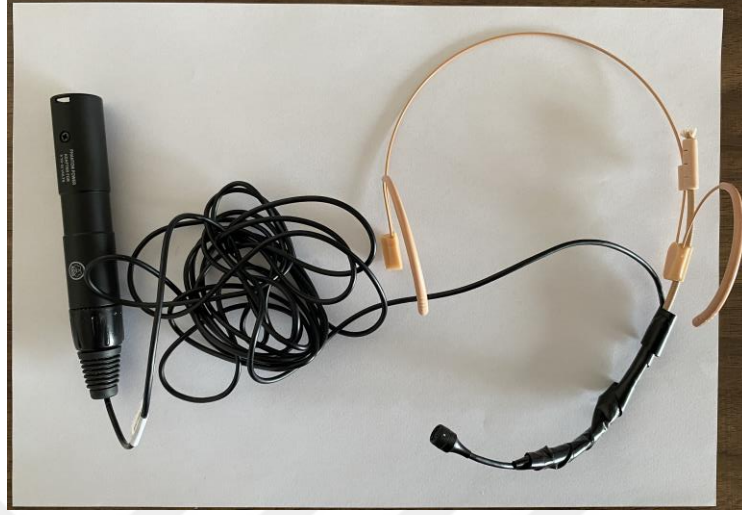
Görsel 3.1. Araştırmada kullanılan modifiye edilmiş kafa mikrofonu
