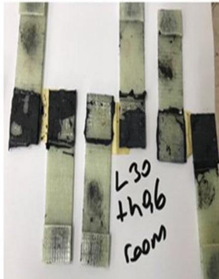
Şekil 5.10. Oda sıcaklığında termal yaşlanma olmayan numunelerin test sonrası hasar tipi
