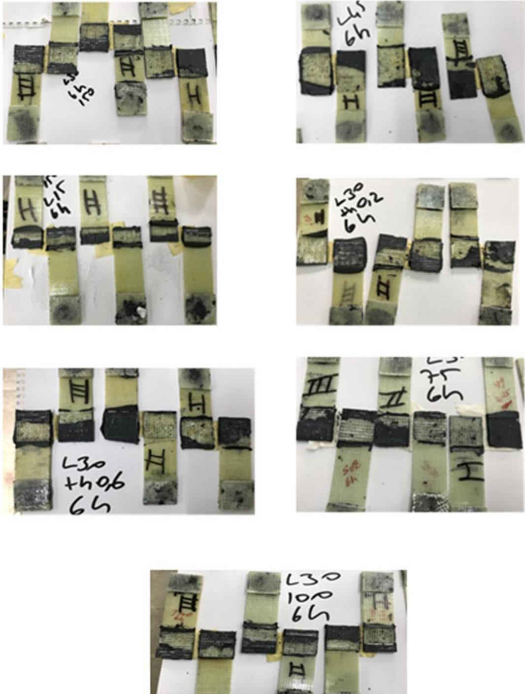
Şekil 5.13. Altı saat termal yaşlanma sonrası test uygulanan numunelerde görülen hasar
