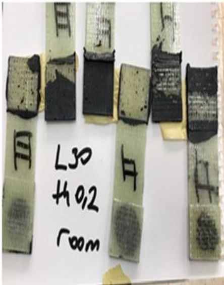
Şekil 5.10. Oda sıcaklığında termal yaşlanma olmayan numunelerin test sonrası hasar tipi
