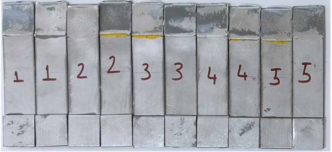
Şekil 5.9. NPTY modeli çekme deneyleri sonucu oluşan hasar yüzeyleri.
