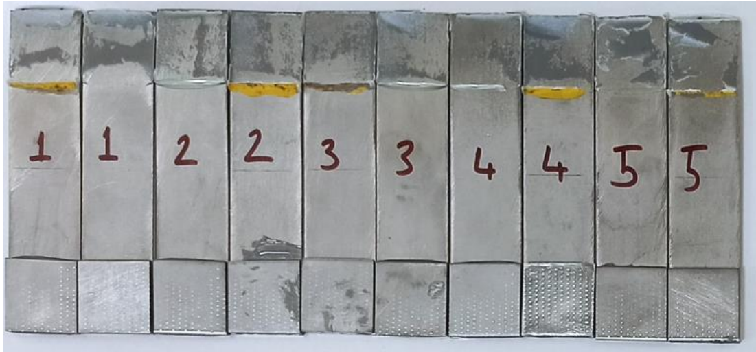
Şekil 5.8. SY modeli çekme deneyleri sonucu oluşan hasar yüzeyleri.
