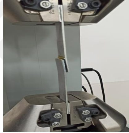
Şekil 4.14. Çekme deneylerinin uygulanması.
