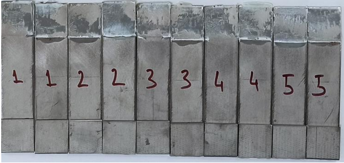
Şekil 5.12. NPTY +CFK ( 0^\circ/90^\circ ) modeli çekme deneyleri sonucu oluşan hasar yüzeyleri.
