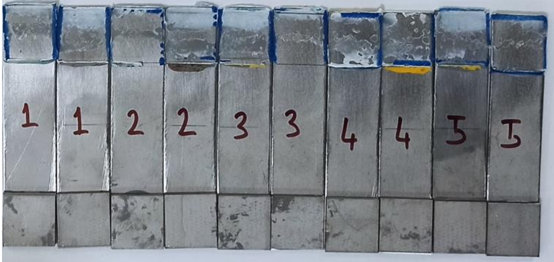
Şekil 5.13. NPTY +CFK ( +45^\circ/-45^\circ ) modeli çekme deneyleri sonucu oluşan hasar yüzeyleri.
