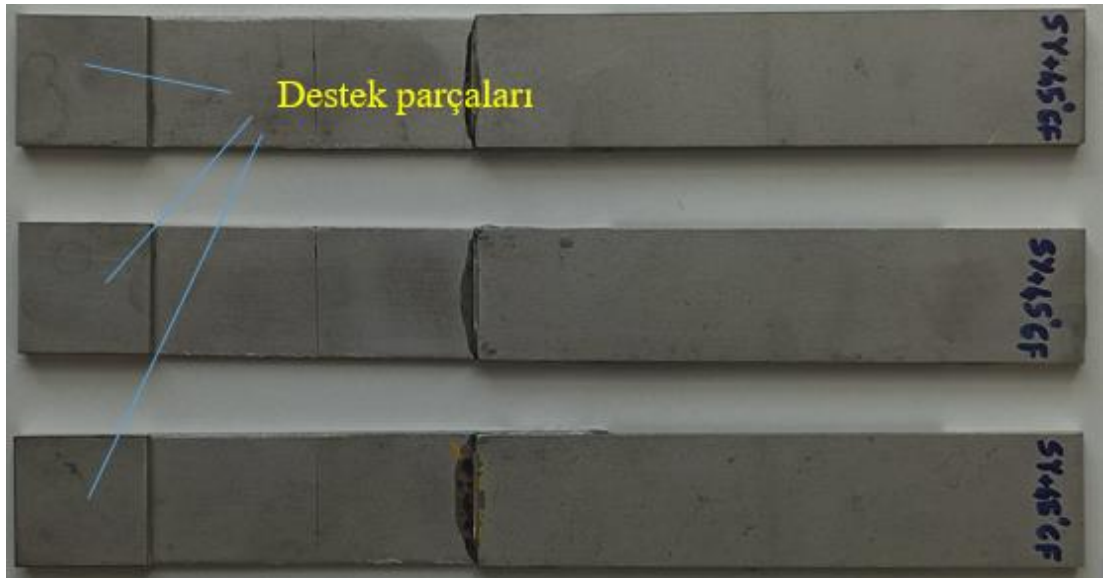
Şekil 4.12. Tek tesirli yapıştırma bağlantı numuneleri.
