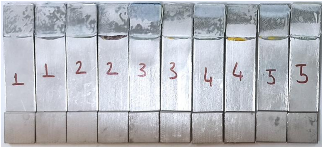
Şekil 5.11. SY +CFK (+45°/-45°) modeli çekme deneyleri sonucu oluşan hasar yüzeyleri.
