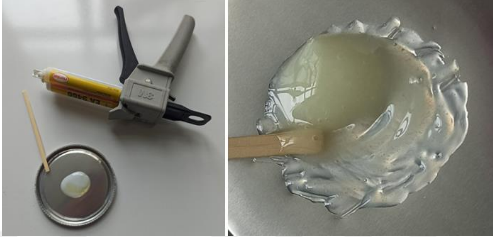
Şekil 4.8. Saf yapıştırıcı hazırlama aşaması.
