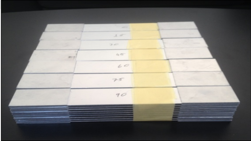
Şekil 3.3. İmalat sonrası GLARE-2-3/2 deney numunesi
