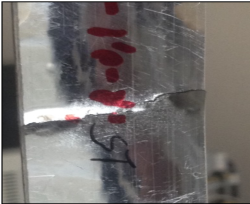
Şekil 3.11. Numune yüzey çatlağı
