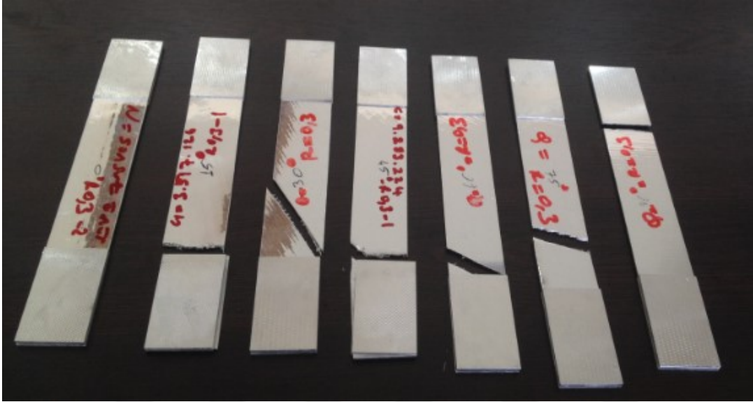
Şekil 3.13. R = 0,3 yükleme oranı için oryantasyon açılarına bağlı kopma şekilleri
