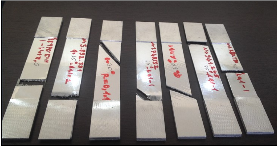
Şekil 3.14. R = 0,1 yükleme oranı için oryantasyon açılarına bağlı kopma şekilleri
