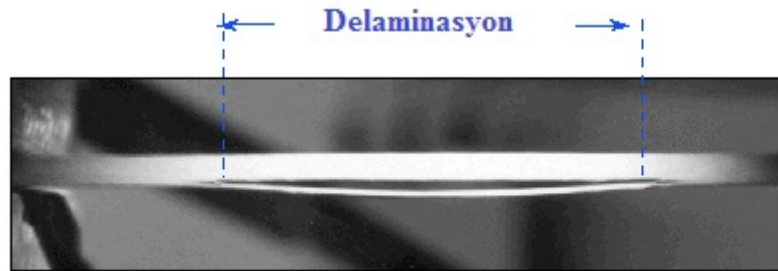
Şekil 2.25. Kompozit malzemede başlangıç delaminasyonu (PD) [41]
