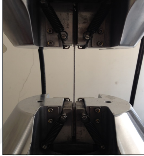
Şekil 3.10. Numunenin cihaza bağlanması
