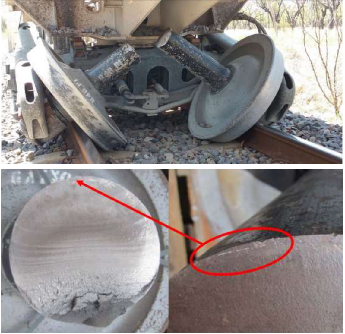
Şekil 1.1. Yorulma Hasarı Sebebiyle Gerçekleşen Tren Kazası, Avustralya-2017
