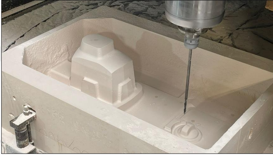
Şekil 3. 27. Klozet kalıbı için hassas operasyonu çalışması. (M. Tolga Berkay arşivi)
