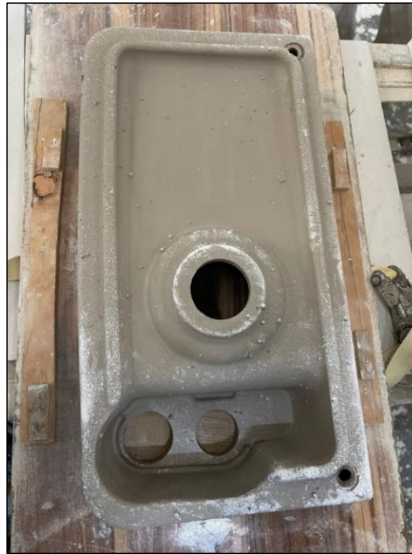
Şekil 3. 43. Lavabonun kalıptan çıkartılıp tezgâha aktarılmış hali. (M. Tolga Berkay arşivi)
