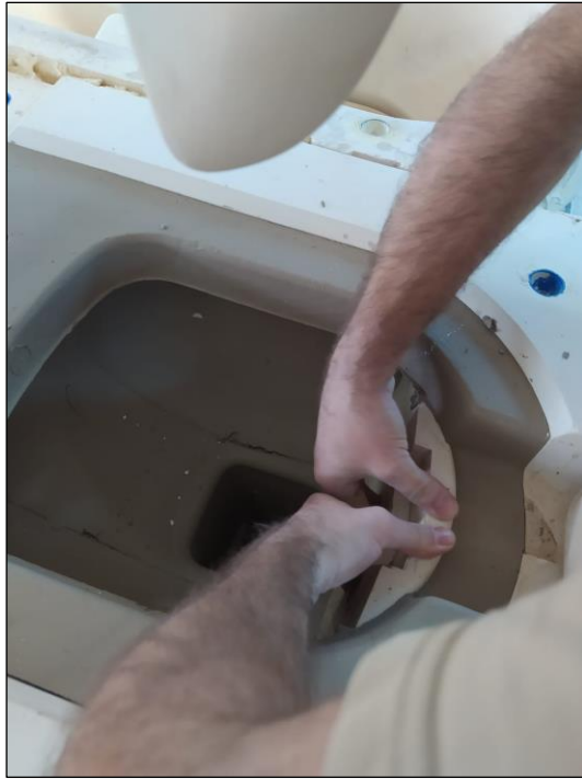
Şekil 3. 39. Klozetin hazne bölgesini oluşturan manyetik parçaların çıkartılmış hali. (M. Tolga Berkay arşivi)
