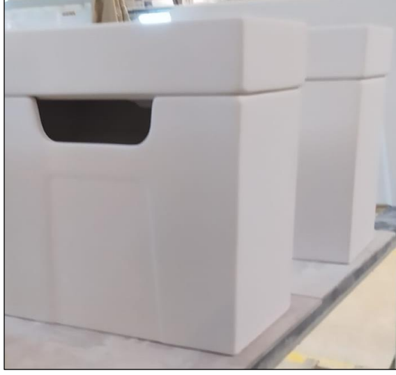
Şekil 3. 52. Fırın vagonuna yüklenmiş olan, Rezervuar yarı mamulü. (M. Tolga Berkay arşivi)
