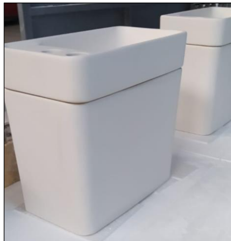
Şekil 3. 50. Sırlama işlemi tamamlanmış, bedensel engellilere ait rezervuar ve lavabo örneği. (M. Tolga Berkay arşivi)
