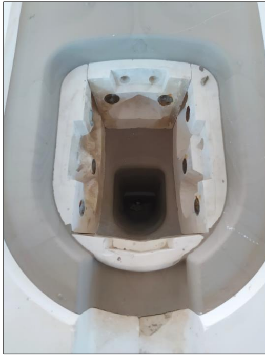
Şekil 3. 37. Kalıp üst parçasının açılması tamamlanmış klozet kalıbı. (M. Tolga Berkay arşivi)
