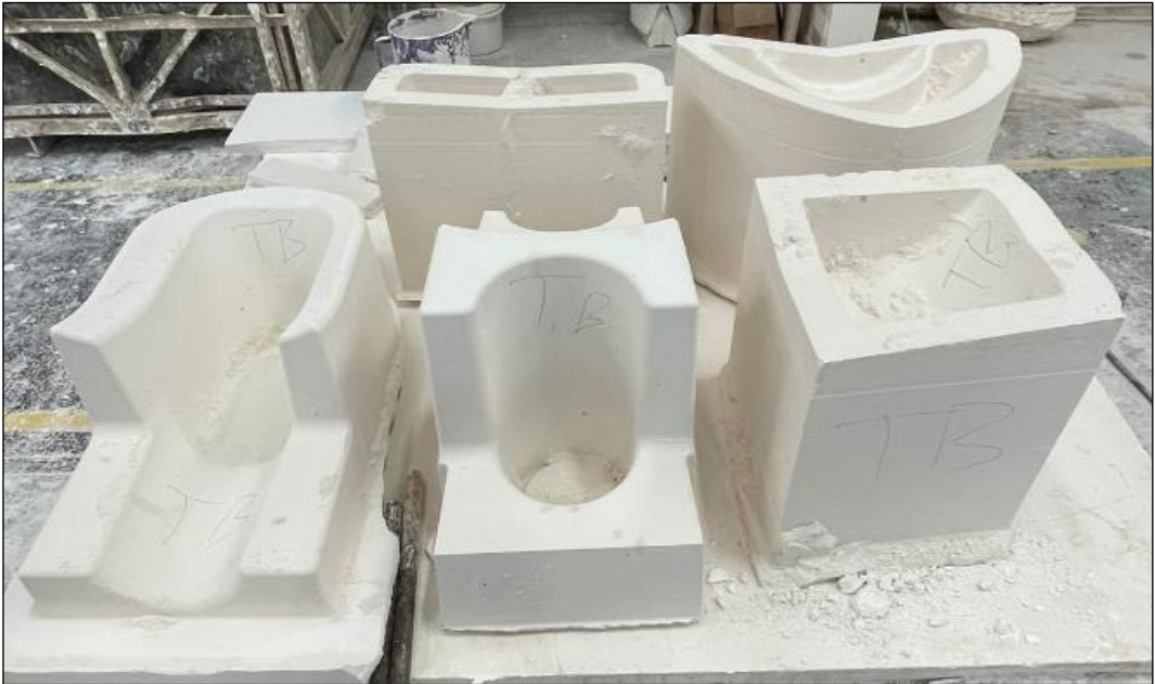
Şekil 3. 32. CNC tezgahında işlenmiş olan, klozet kalıbına ait diğer parçalar. (M. Tolga Berkay arşivi)
