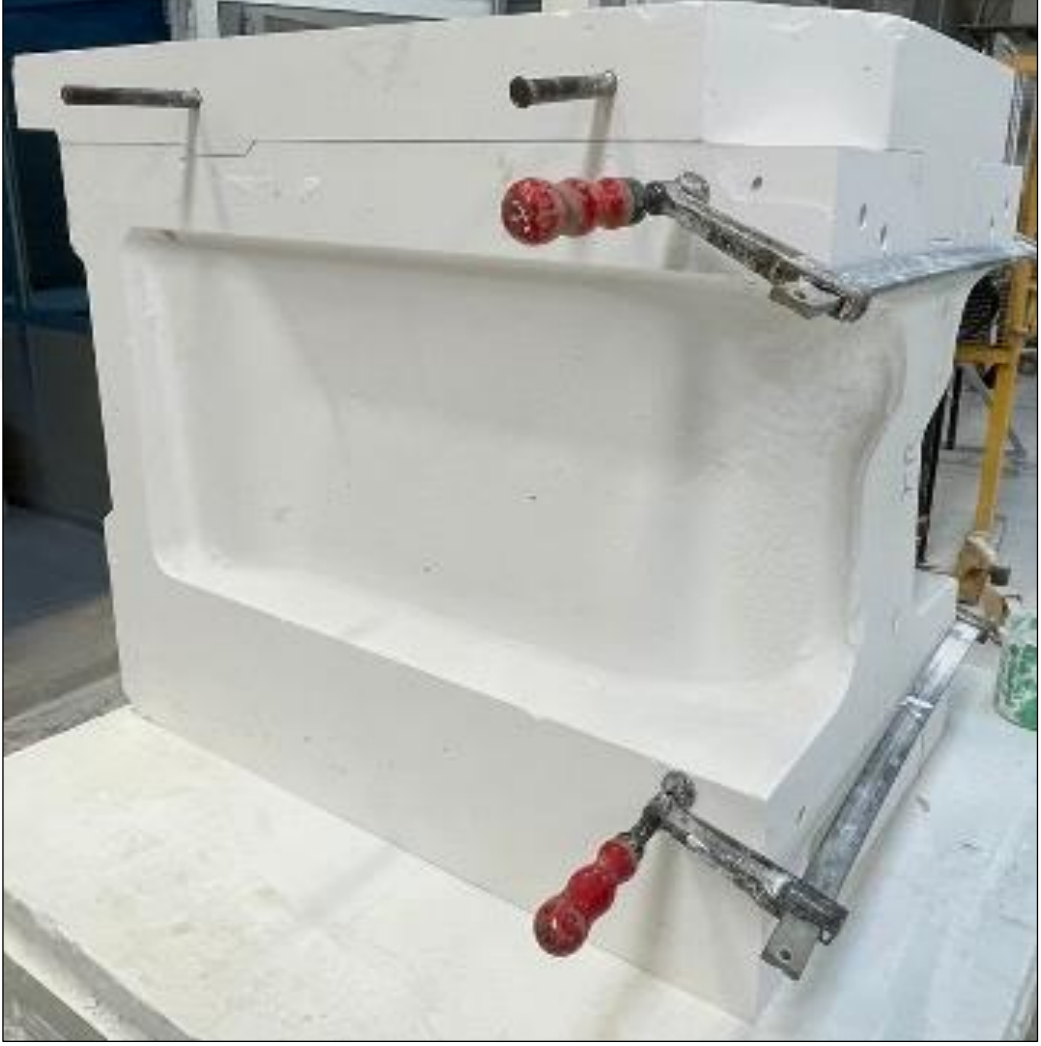
Şekil 3. 35. Rötüş işlemi tamamlanan kalıp parçalarının toplama aşaması. (M. Tolga Berkay arşivi)
