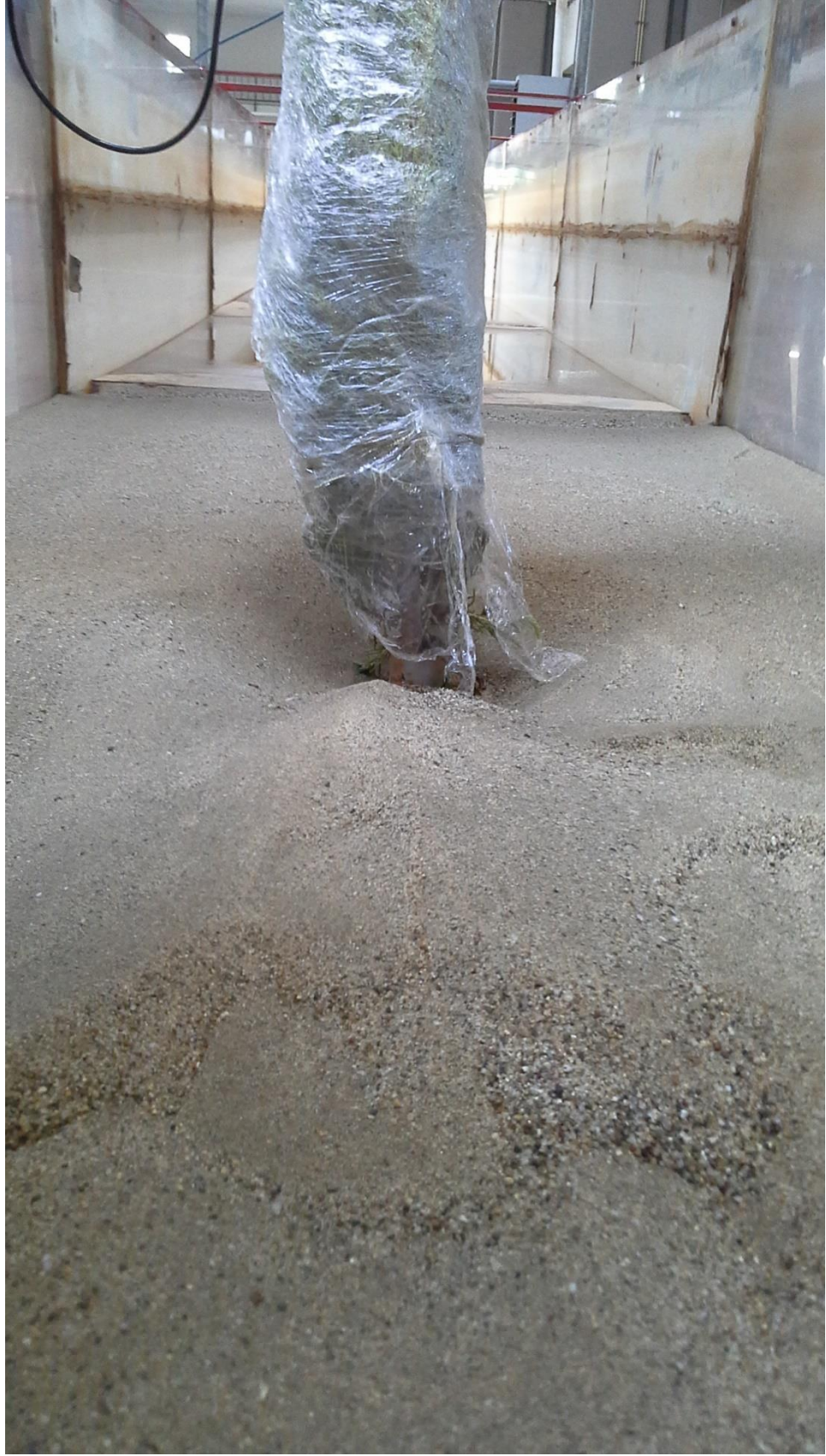
Şekil D.4: Deney 6 sonrası geçirimsiz bitki etrafındaki oyulma desenleri.
