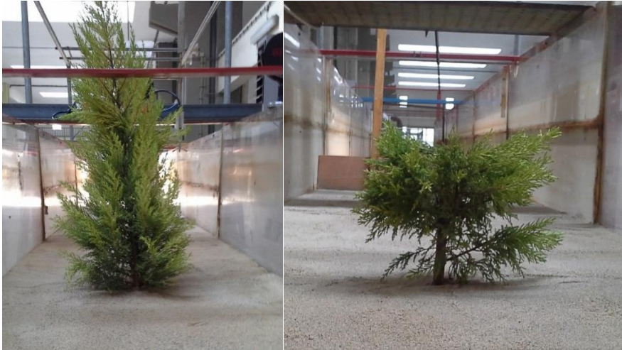
Şekil 3.4: Akıma batmış ve batmamış durumdaki bitkilerin görünümü
