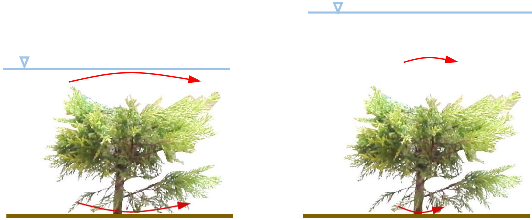
Şekil 4.16: Daralma nedeniyle bitkinin neden olduğu kanopi-altı ve kanopi-üstü akım
