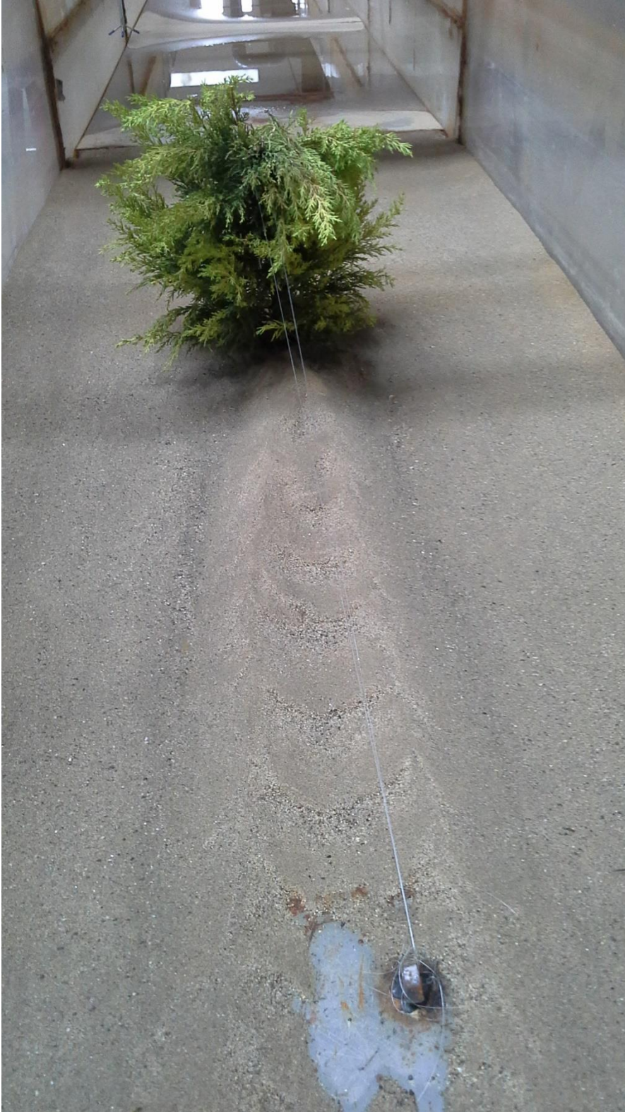
Şekil D.5: Deney 7 sonrası eğik bitki etrafındaki oyulma desenleri.
