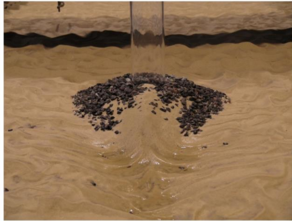
Şekil 2.8: Oyulma önleyiciler yerleştirilmiş dik silindirin etrafından geçen akım (Petersen 2014).
