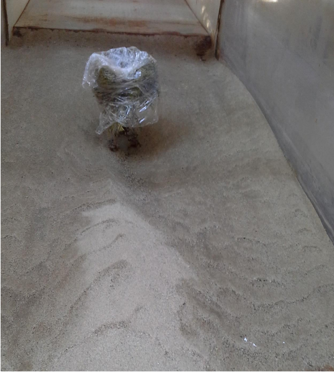
Şekil D.10: Deney 12 sonrası batık ve geçirimsiz bitki elemanı etrafındaki oyulma deseni.
