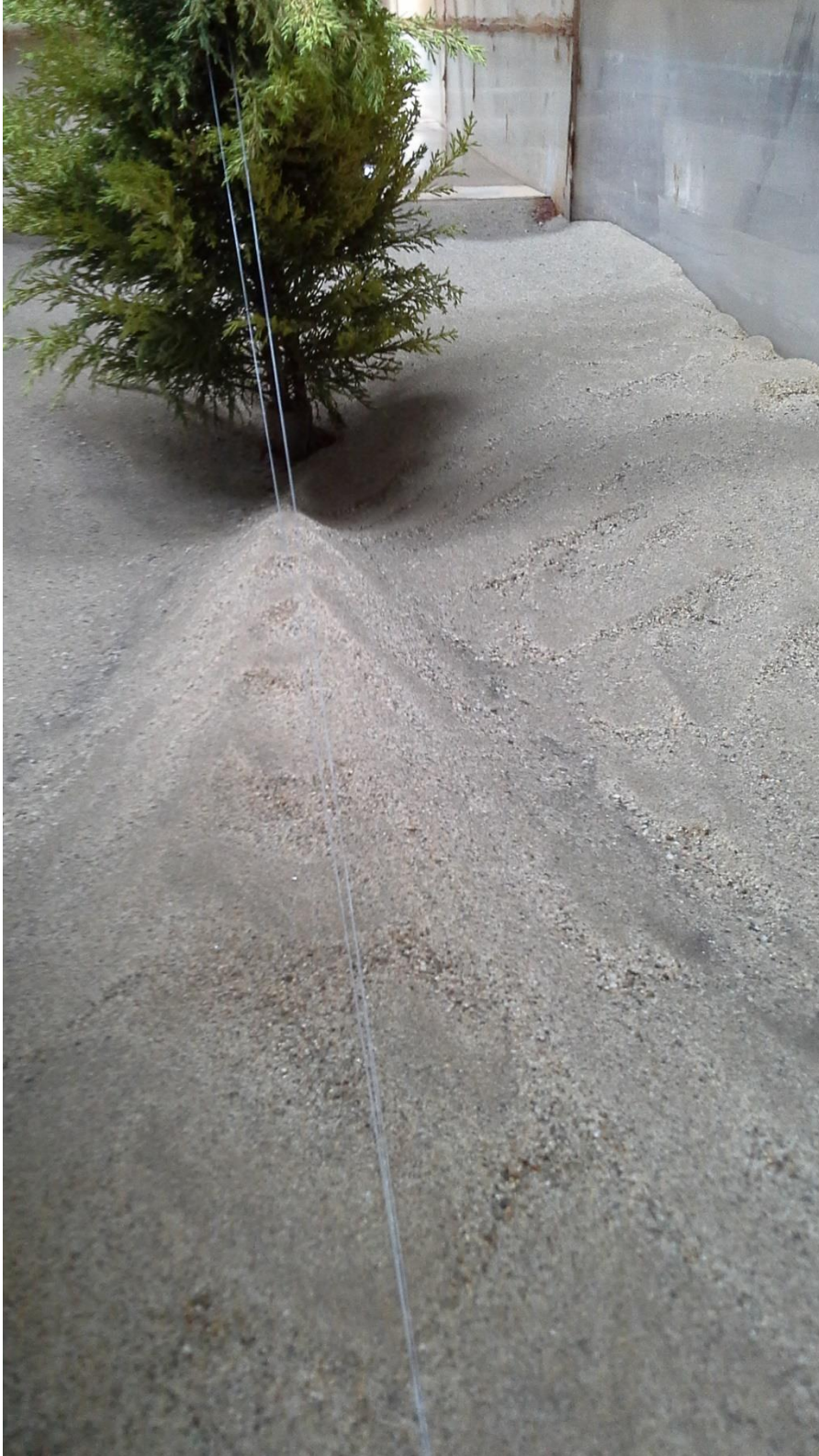
Şekil D.6: Deney 8 sonrası eğik bitki etrafındaki oyulma desenleri.
