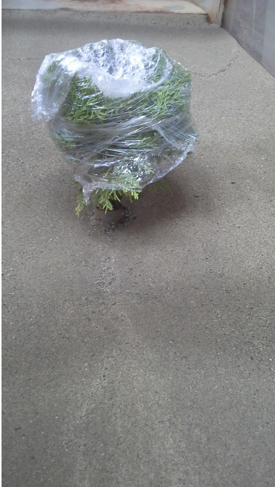
Şekil D.9: Deney 11 sonrası batık ve geçirimsiz bitki elemanı etrafındaki oyulma deseni.
