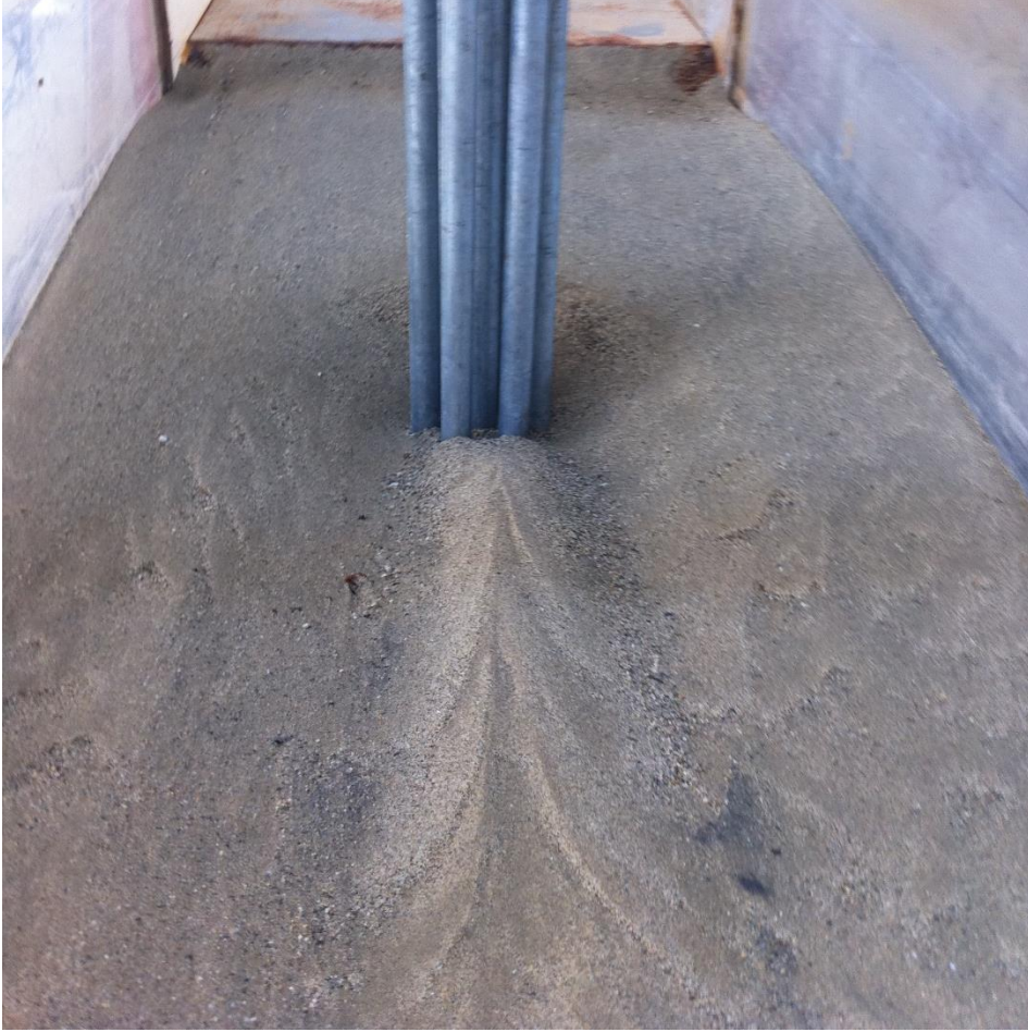
Şekil D.12: Deney 14 sonrası altıgen biçiminde yerleştirilmiş silindirlerin etrafındaki oyulma deseni.
