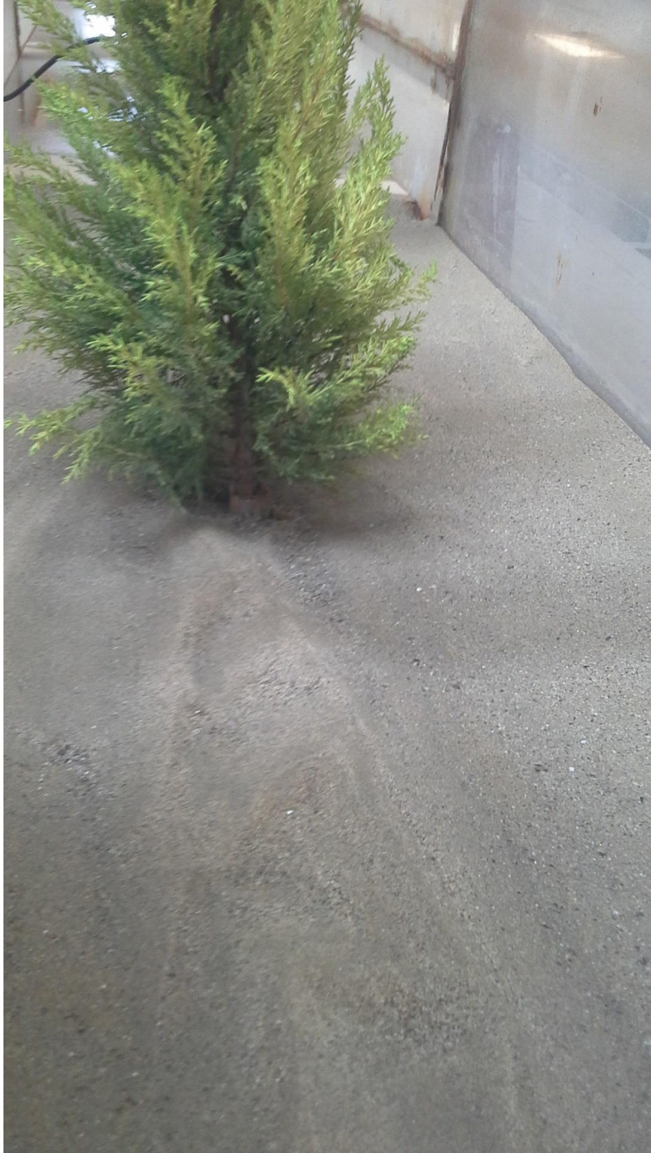
Şekil D.2: Deney 4 sonrası bitki etrafındaki oyulma desenleri.
