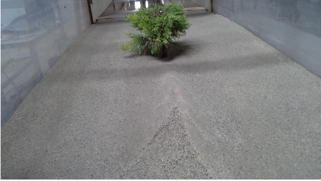
Şekil D.7: Deney 9 sonrası batık bitki elemanı etrafındaki oyulma deseni.
