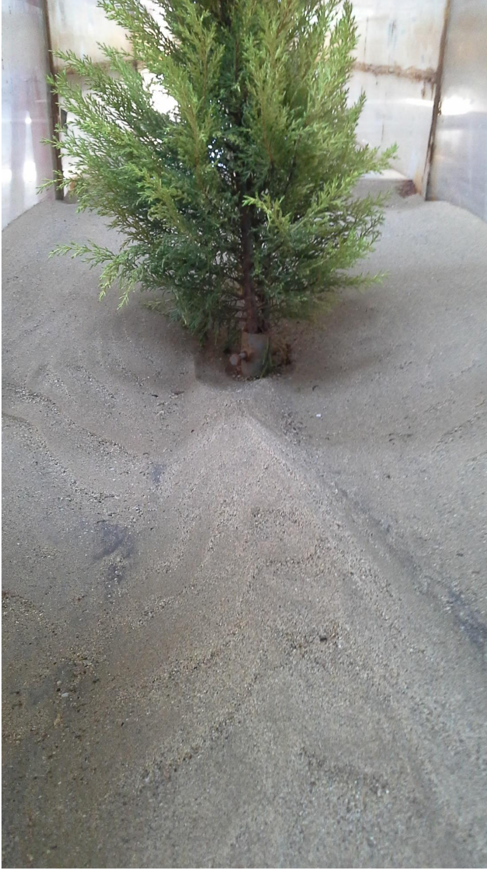
Şekil D.3: Deney 5 sonrası bitki etrafındaki oyulma desenleri.
