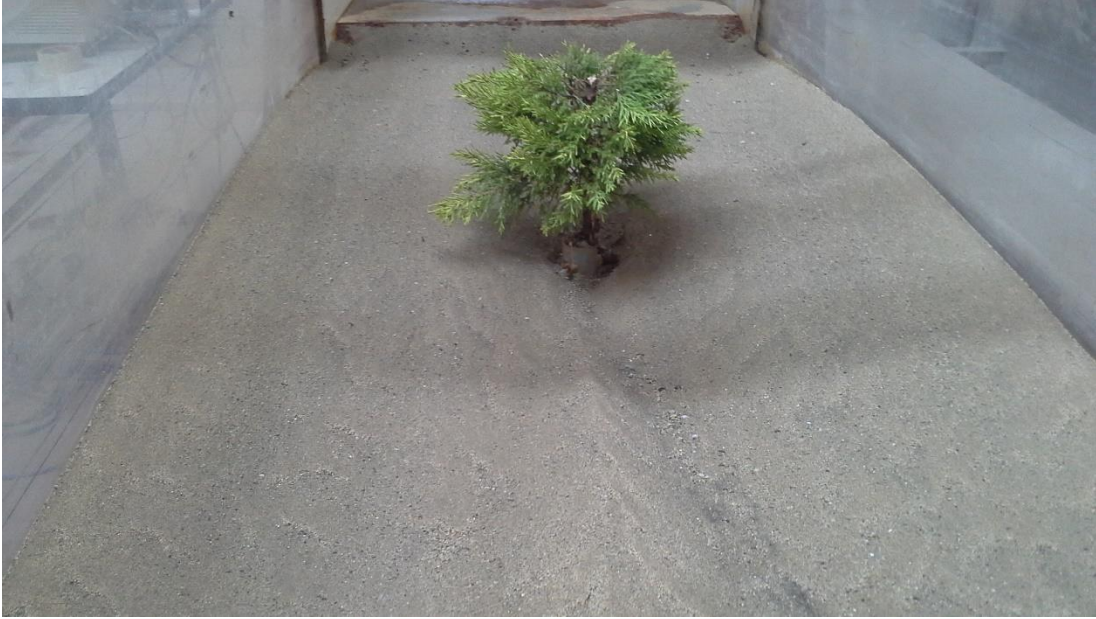
Şekil D.8: Deney 10 sonrası batık bitki elemanı etrafındaki oyulma deseni.
