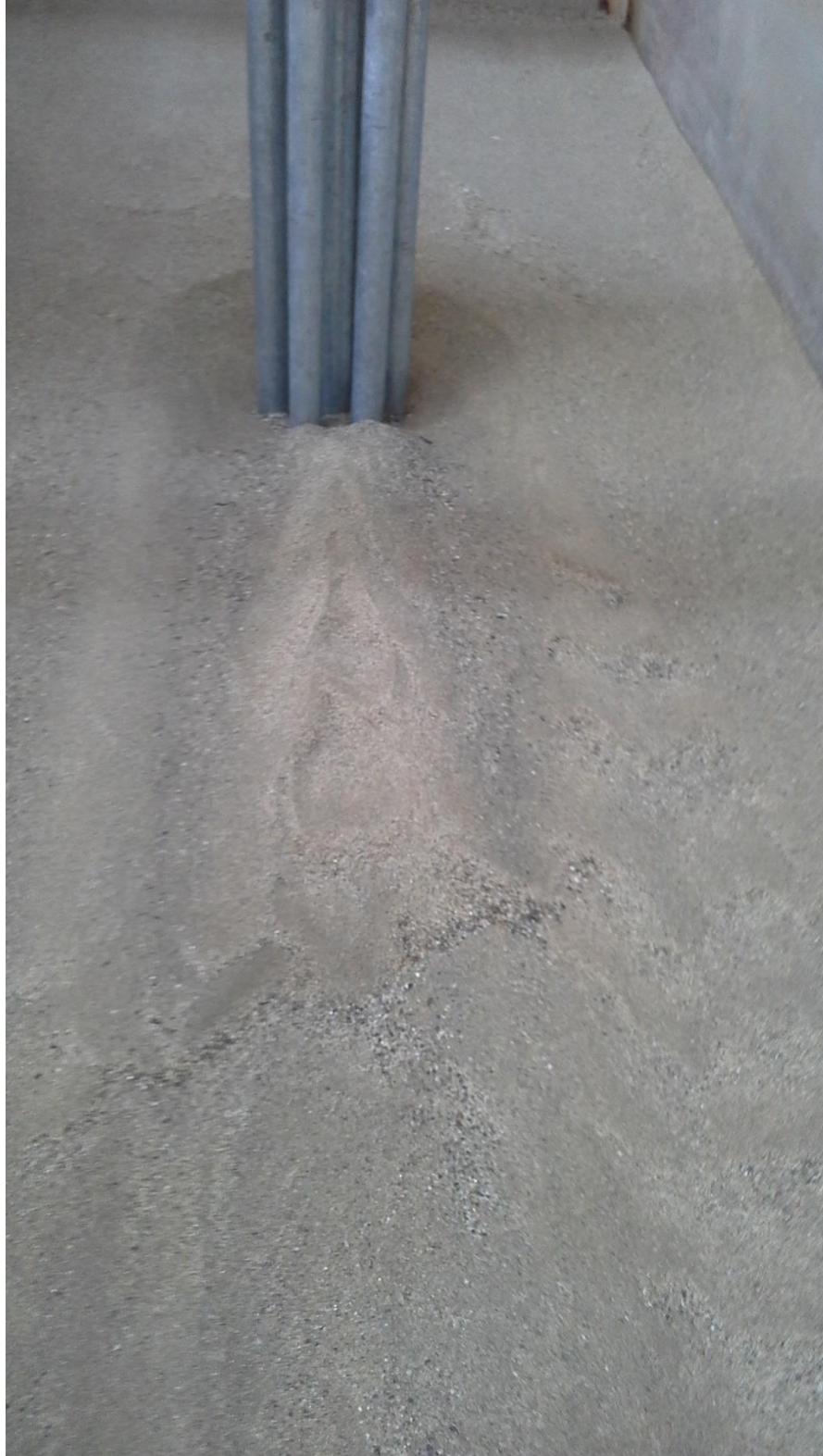
Şekil D.11: Deney 13 sonrası altıgen biçiminde yerleştirilmiş silindirlerin etrafındaki oyulma deseni.
