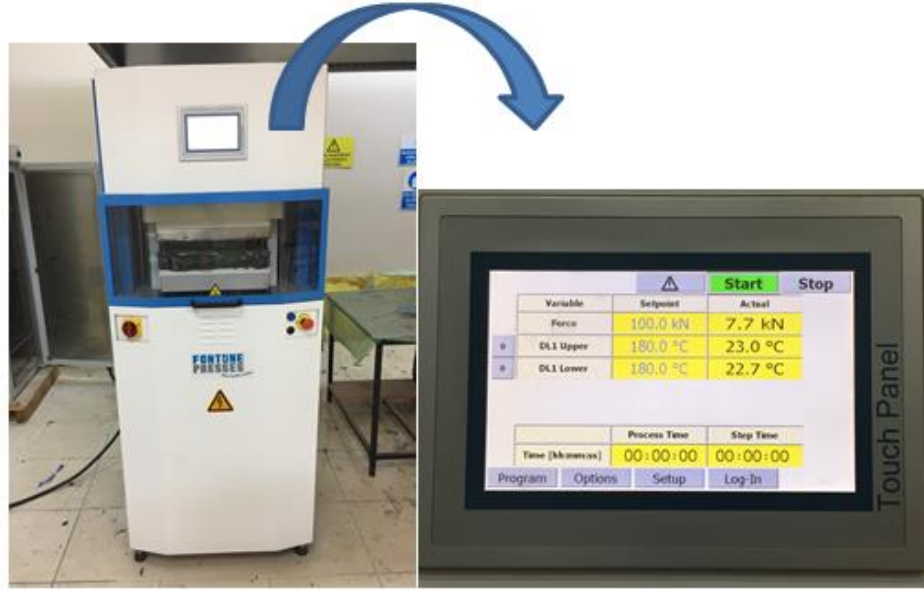
Şekil 6.1 Fontijne presses labecon600 marka sıcak pres cihazı (Kişisel arşiv, 2019)
