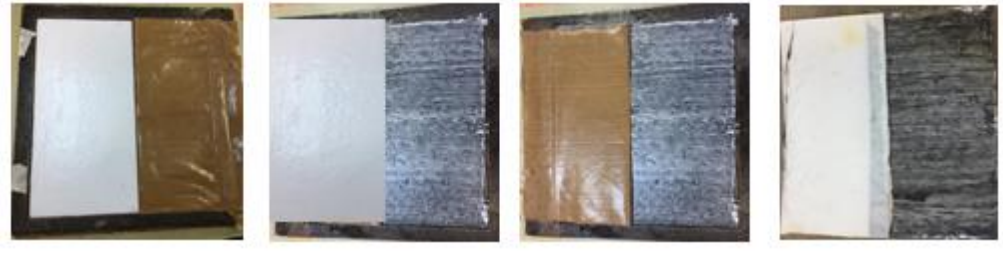
Şekil 6.7 Kompozit-YYPE levha birleşiminin işlem sırası (Kişisel arşiv, 2019)
