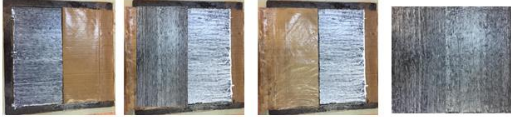
Şekil 6.8 Kompozit-kompozit levha birleşiminin işlem sırası (Kişisel arşiv, 2019)
