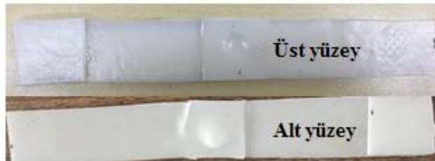
Şekil 7.17 YYPE-YYPE birleşiminde 10J'de darbe sonrası hasar şekilleri (Kişisel arşiv, 2019)
