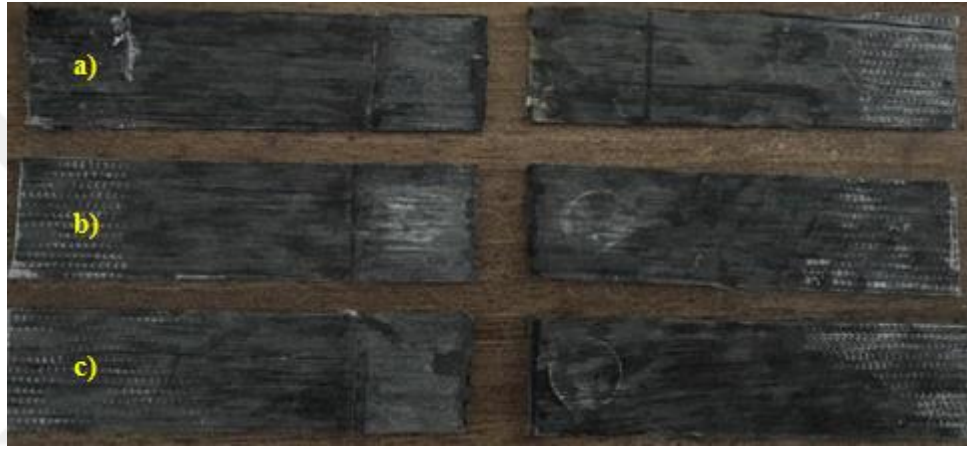
Şekil 7.30 Kompozit-Kompozit birleşiminde 75°C çekme deneyi sonrası numuneler a) 0J darbe enerji, b) 5J darbe enerji, c) 10J darbe enerjili (Kişisel arşiv, 2019)
