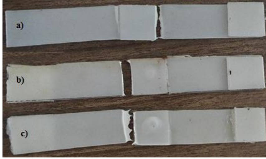
Şekil 7.22 YYPE-YYPE birleşiminde 25°C çekme deneyi sonrası numuneler a) 0J darbe enerji, b) 5J darbe enerji, c) 10J darbe enerjili (Kişisel arşiv, 2019)
