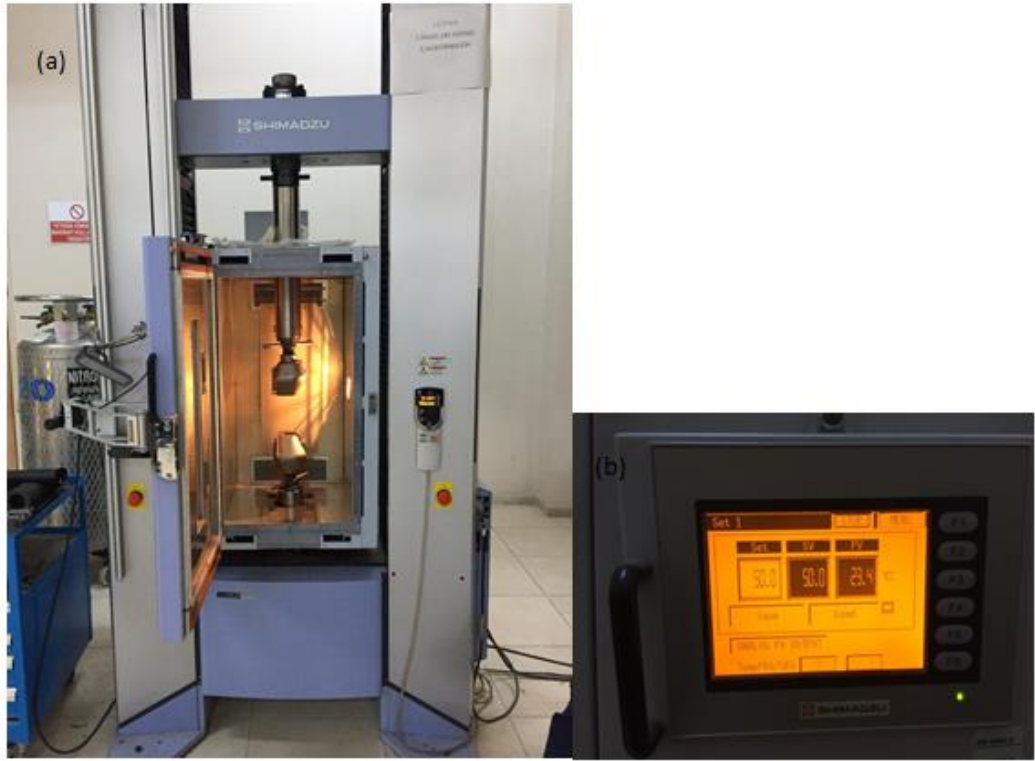
Şekil 6.3 (a) Shimadzu AG-Xserisi universal çekme test cihazı, (b) iklimlendirme kabini ekranı (Kişisel arşiv, 2019)
