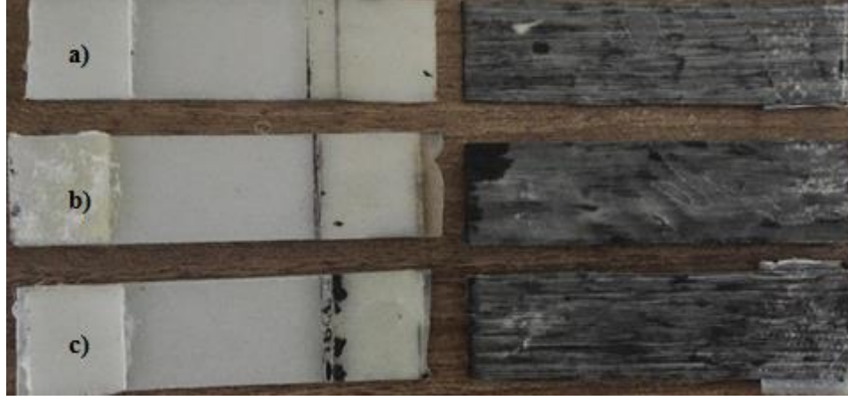
Şekil 7.27 Kompozit-YYPE birleşiminde 75°C çekme deneyi sonrası numuneler a) 0J darbe enerjisi, b) 5J darbe enerjisi, c) 10J darbe enerjisi (Kişisel arşiv, 2019)
