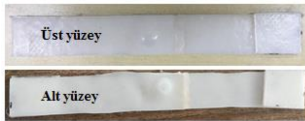
Şekil 7.16 YYPE-YYPE birleşiminde 5J'de darbe sonrası hasar şekilleri (Kişisel arşiv, 2019)
