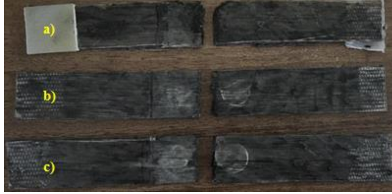
Şekil 7.29 Kompozit-Kompozit birleşiminde 50°C çekme deneyi sonrası numuneler a) 0J darbe enerji, b) 5J darbe enerji, c) 10J darbe enerjili (Kişisel arşiv, 2019)
