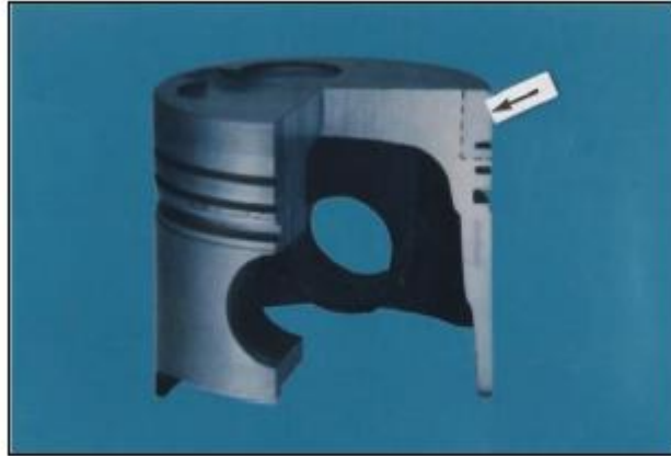
Şekil 2.5 Kısa fiber takviyeli alüminyum alaşımlı metal matrisli kompozitten yapılmış piston kafası (Chawla, 2012)
