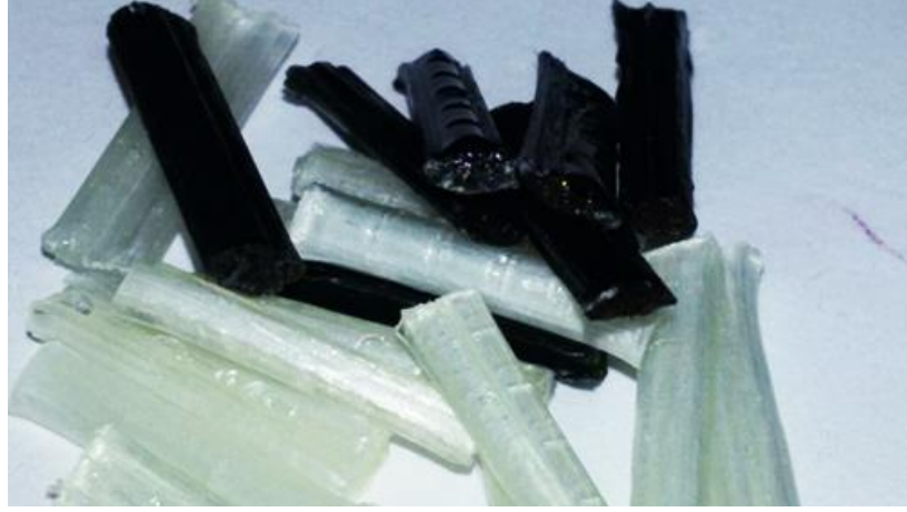
Şekil 5.9 Pulrüzyon yöntemiyle üretilmiş uzun cam elyaf takviyeli polipropilen granül (Nuh Kompozit, 2019)
