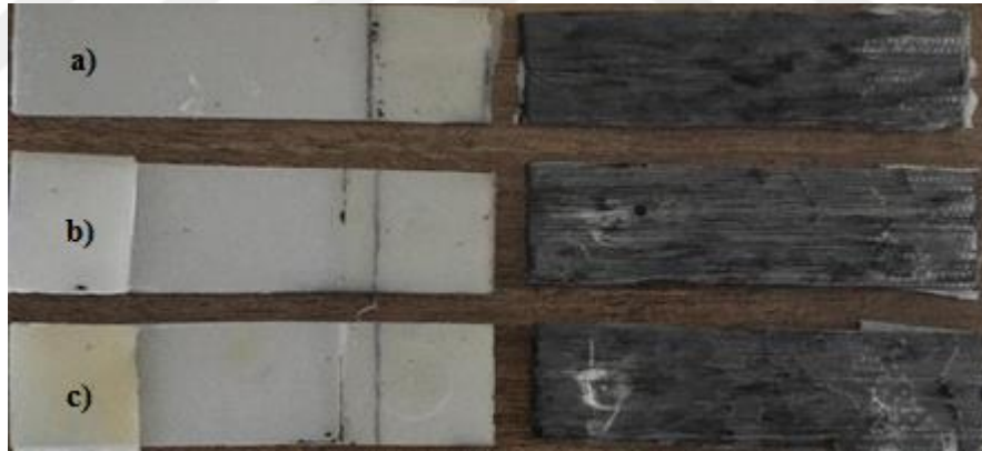
Şekil 7.26 Kompozit-YYPE birleşiminde 50°C çekme deneyi sonrası numuneler a) 0J darbe enerjisi, b) 5J darbe enerjisi, c) 10J darbe enerjisi (Kişisel arşiv, 2019)
