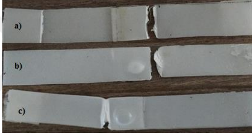
Şekil 7.23 YYPE-YYPE birleşiminde 50°C çekme deneyi sonrası numuneler a) 0J darbe enerji, b) 5J darbe enerji, c) 10J darbe enerjili (Kişisel arşiv, 2019)
