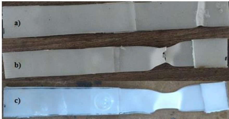
Şekil 7.24 YYPE-YYPE birleşiminde 75°C çekme deneyi sonrası numuneler a) 0J darbe enerji, b) 5J darbe enerji, c) 10J darbe enerjili (Kişisel arşiv, 2019)
