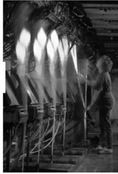
Şekil 5.5 Cam elyafın üretim yöntemi (Campbell, 2010)
