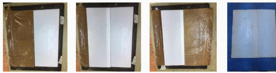
Şekil 6.6 YYPE-YYPE levha birleşiminin işlem sırası (Kişisel arşiv, 2019)
