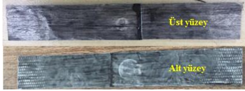
Şekil 7.20 Kompozit-Kompozit Birleşiminde 5J’de darbe sonrası hasar şekilleri (Kişisel arşiv, 2019)
