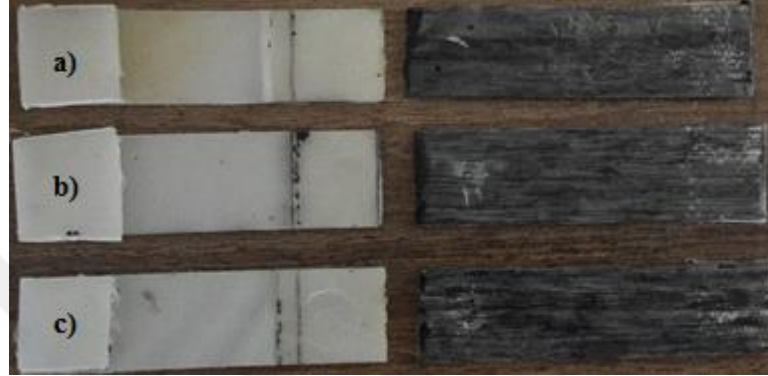
Şekil 7.25 Kompozit-YYPE birleşiminde 25°C çekme deneyi sonrası numuneler a) 0J darbe enerjisi, b) 5J darbe enerjisi, c) 10J darbe enerjisi (Kişisel arşiv, 2019)
