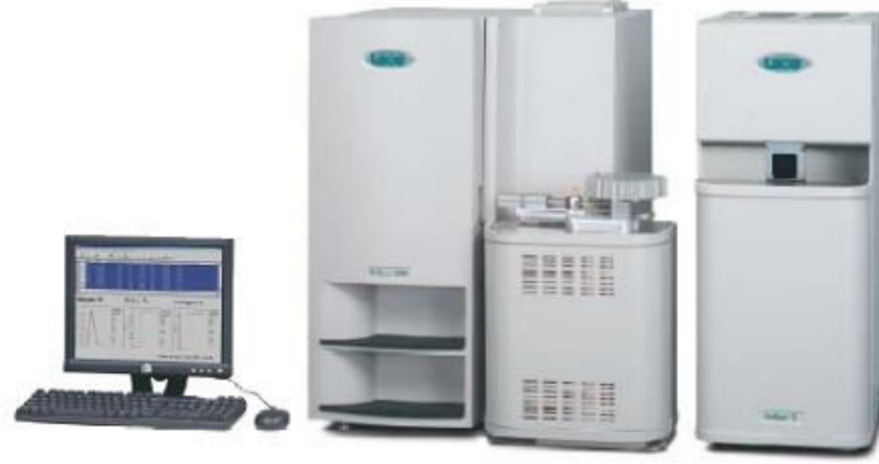
Şekil 7.3 : Leco TruSpec® CHN model elementel analiz cihazı ve S modülü.
