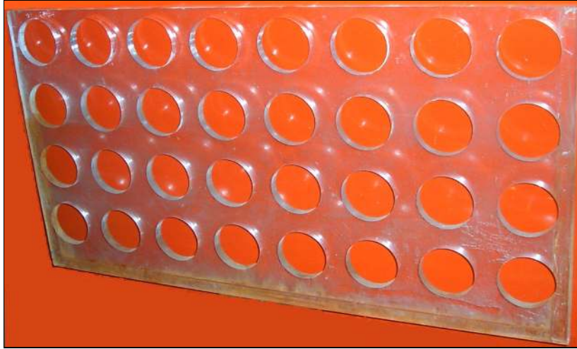
Şekil 4.5 %40 poroziteli perfore duvar modeli
