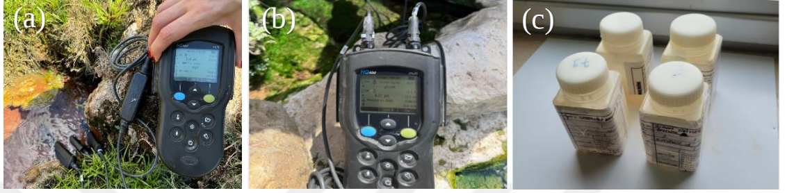
Şekil 3. (a) Çoklu parametre ölçer, (b) gaz ölçüm aleti, (c) su örneklerinin alındığı polietilen şişeler
