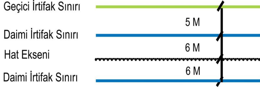
Şekil 2.2. Boru Hattı Güzergâhına ait genişlik bilgileri örneği
