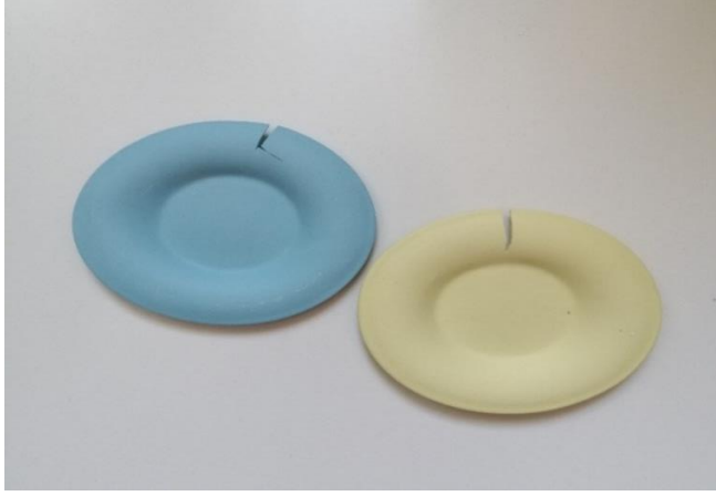
Şekil 31. İlk pişirim sonrası oluşan çatlak.
