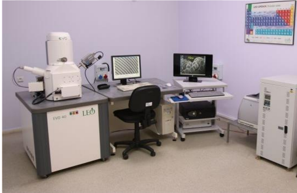
Şekil 3.24. TEM Ünitesi: LEO-EVO 40/Cambridge-İngiltere
