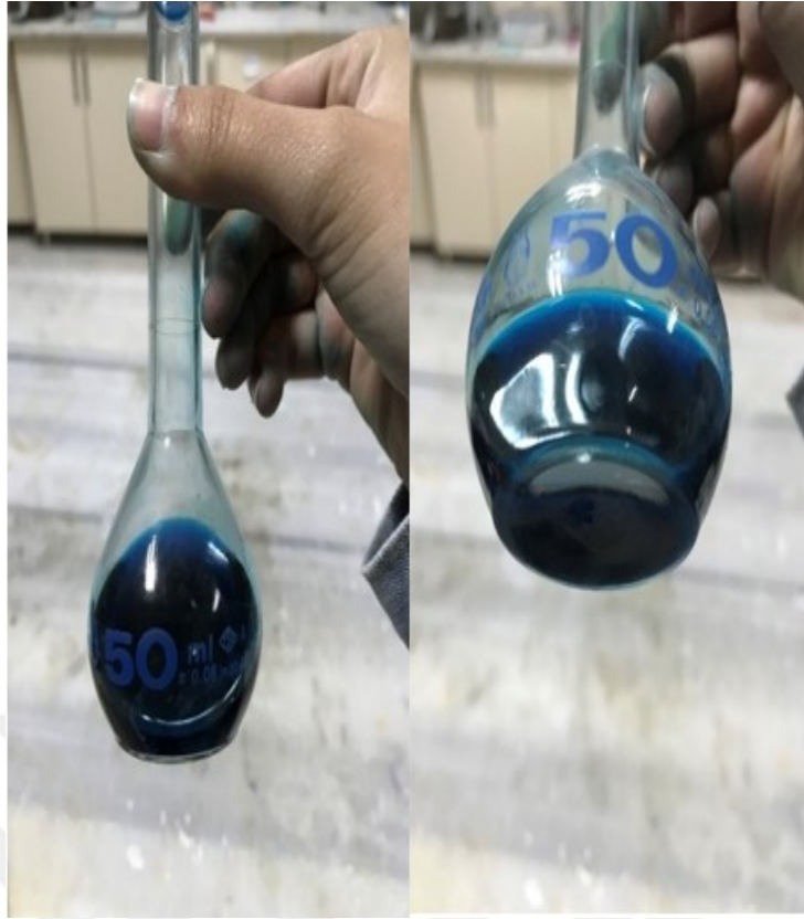
Şekil 27. Remazol navy blue 250 reaktif boyar maddesinin sodyum karbonatlı suda çözünmesi.
