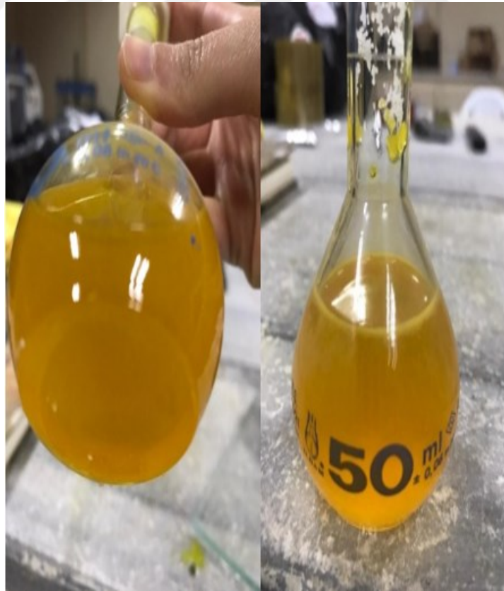
Şekil 28. Remazol yellow 37 reaktif boyar maddesinin sodyum karbonatlı suda çözünmesi.
