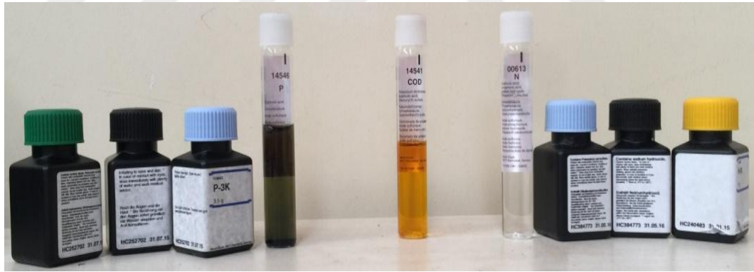
Şekil 8.11. Merck Fosfat ( \text{PO}_4\text{-P} ), COD (KOİ), Azot (N) ölçüm kitleri.
