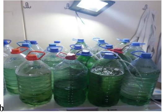
Şekil 3.4. Büyük hacimde üretilen mikroalgler a. Başlangıç kültürler, b. Logaritmik gelişme fazının sonundaki kültürler.
