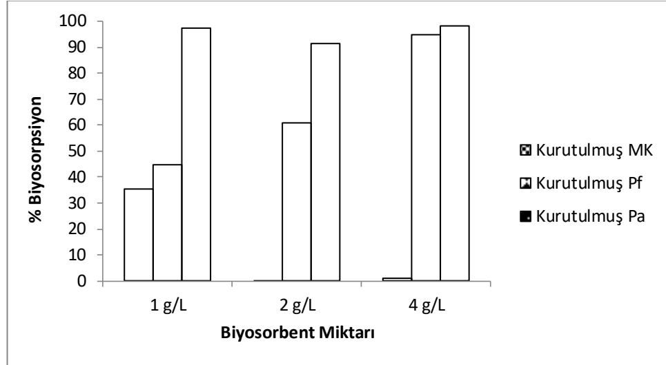
Şekil 4.18. Kurutulmuş biyosorbentler ile RBB'nin biyosorpsiyonunda biyosorbent miktarı etkisi.
